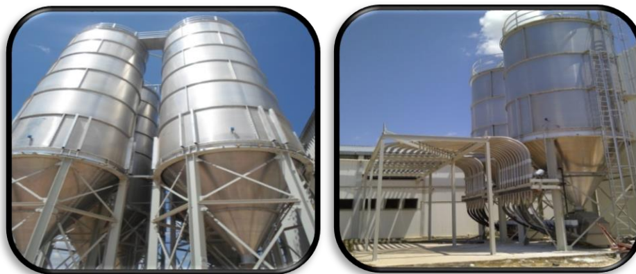
Anexo A: Silos de Almacenamiento de Resina y Compuesto de PVC Materia Prima
