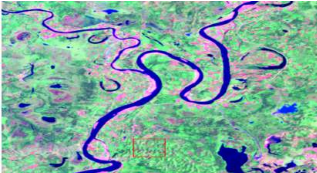
Figura 4. Río Coatzacoalcos en la zona intermedia, meandros abandonados, cuatro grados de libertad Fuente: adaptado de Maza y García, (1996)
