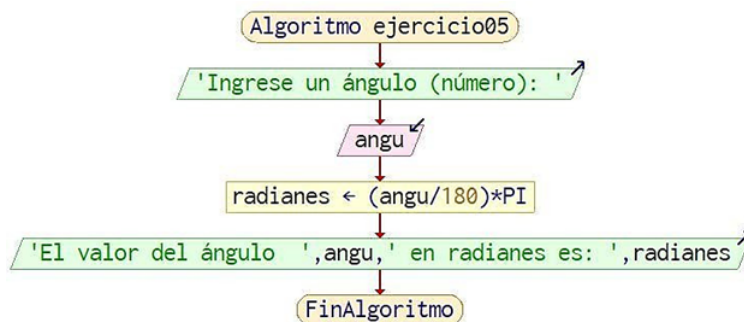
Figura 21: Diagrama de flujo del algoritmo de conversión de grados a radianes.
