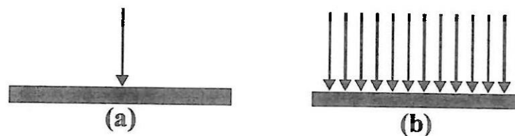
Figura 7.11. Tipos de fuerzas que actúan sobre un Cuerpo: (a.) Concentrada y (b) Distribuidas.
