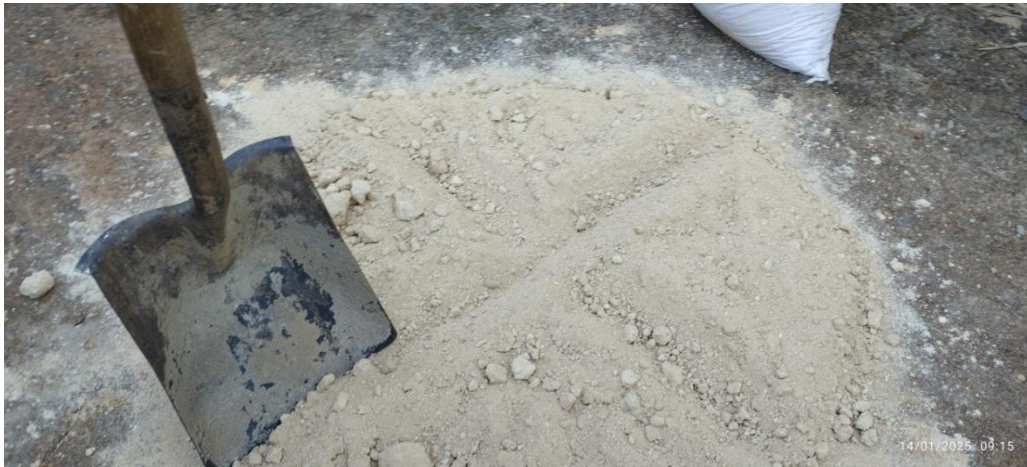
Cuarteo (Para Análisis Granulométrico)
