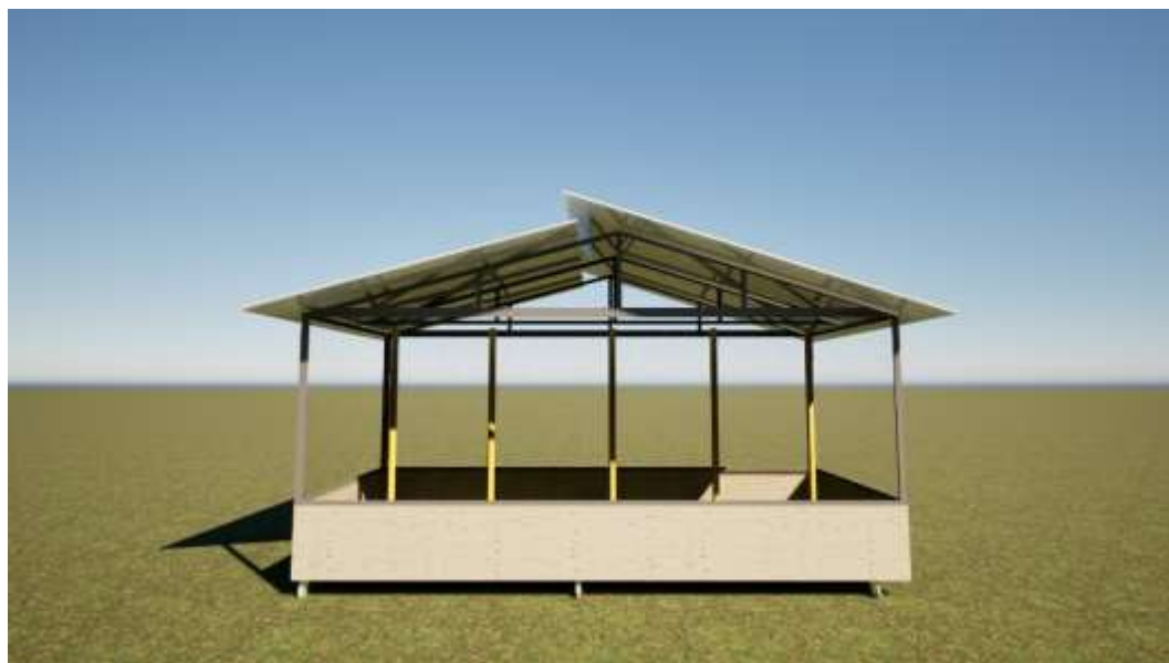
Fig. 3. Vista del corral y forma del techo para permitir buen flujo de aire. Fuente: Elaboración propia (2025).
