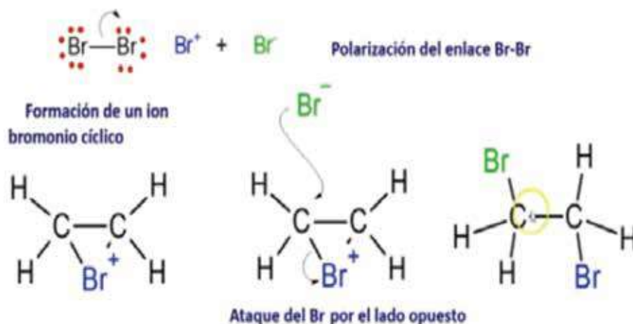
Figura 4.8. Mecanismo de adición electrofílica
