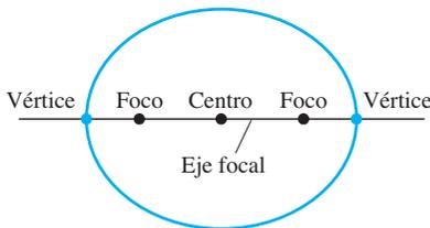
FIGURA 11.39 Puntos en el eje focal de una elipse.
