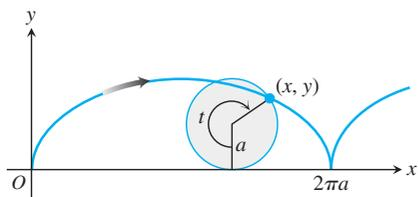
**FIGURA 11.9** La curva cicloide  $x = a(t - \sin t)$ ,  $y = a(1 - \cos t)$ , para  $t \geq 0$ .
