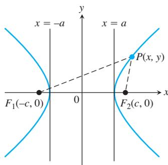
**FIGURA 11.43** Las hipérbolas tienen dos ramas. Para puntos en la rama derecha de la hipérbola mostrada aquí,  $PF_1 - PF_2 = 2a$ . Para los puntos en la rama izquierda de la hipérbola mostrada aquí,  $PF_2 - PF_1 = 2a$ . Entonces hacemos  $b = \sqrt{c^2 - a^2}$ .
