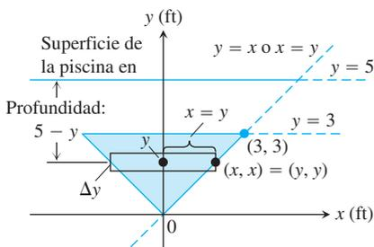
**FIGURA 6.43** Para determinar la fuerza sobre un lado de la placa sumergida del ejemplo 6, utilizamos un sistema de coordenadas como el que se muestra aquí.
