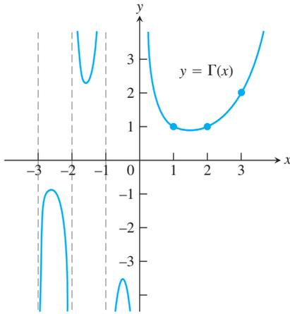
**FIGURA 8.21** La función gamma de Euler,  $\Gamma(x)$ , es una función continua de  $x$ , cuyo valor en cada entero positivo  $n + 1$  es  $n!$ . La fórmula por medio de una integral definida para  $\Gamma$  es válida sólo para  $x > 0$ , pero puede extenderse  $\Gamma$  a valores negativos no enteros de  $x$  con la fórmula  $\Gamma(x) = (\Gamma(x + 1))/x$ , que es tema del ejercicio 31.
