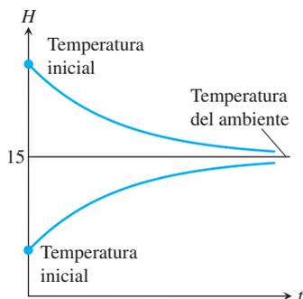
**FIGURA 9.18** Temperatura contra tiempo. Sin importar la temperatura inicial, la temperatura del objeto  $H(t)$  tiende hacia  $15^\circ\text{C}$ , la temperatura del medio que lo rodea.
