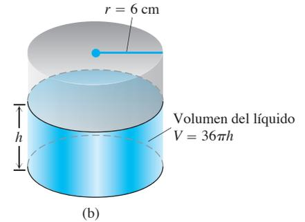
Una taza de medición de 1 litro (a), modelada como un cilindro circular recto (b) de radio  $r = 6$  cm.
