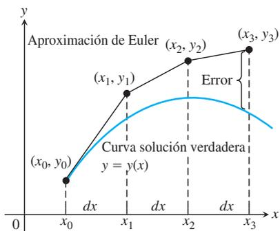
FIGURA 9.6 Tres pasos en la aproximación de Euler a la solución del problema con condición inicial  $y' = f(x, y), y(x_0) = y_0$ . Conforme damos más pasos, por lo común los errores se acumulan, pero no en la forma exagerada en la que se muestra aquí.
