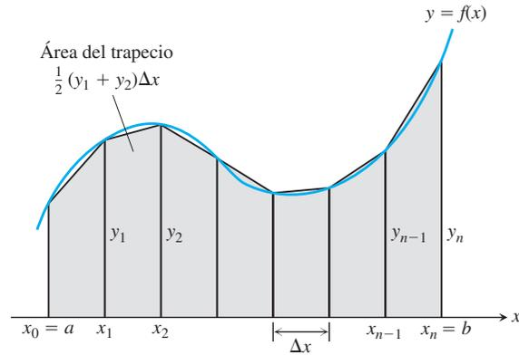
**FIGURA 8.7** La regla del trapecio aproxima pequeñas secciones de la curva  $y = f(x)$  con segmentos de rectas. Para aproximar la integral de  $f$  desde  $a$  hasta  $b$ , sumamos las áreas de los trapecios formados al unir los extremos de los segmentos con el eje  $x$ .
