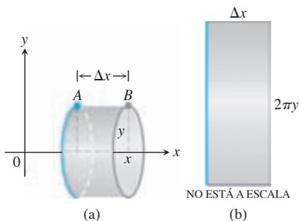
**FIGURA 6.28** Una superficie cilíndrica generada al hacer girar el segmento de recta horizontal  $AB$  de longitud  $\Delta x$  alrededor del eje  $x$  tiene área  $2\pi y \Delta x$ . (b) Al cortar y desenrollar la superficie cilíndrica se obtiene un rectángulo.
