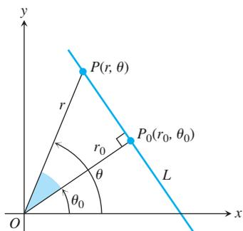
**FIGURA 11.51** Podemos obtener una ecuación polar de la recta  $L$  interpretando la relación  $r_0 = r \cos(\theta - \theta_0)$  en el triángulo rectángulo  $OP_0P$ .
