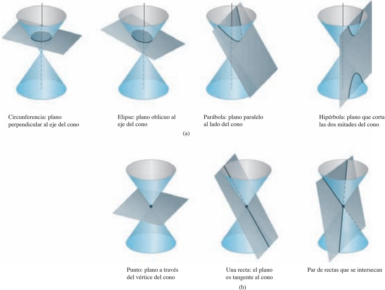
**FIGURA 11.36** Las secciones cónicas estándar (a) son las curvas en las cuales un plano corta a un cono *doble*. Las hipérbolas constan de dos partes, llamadas ramas. El punto y las rectas que se obtienen al hacer pasar el plano por el vértice del cono (b) son secciones cónicas *degeneradas*.
