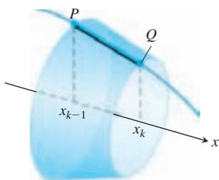
**FIGURA 6.31** Segmento de recta que une a  $P$  y  $Q$  genera un tronco de un cono.
