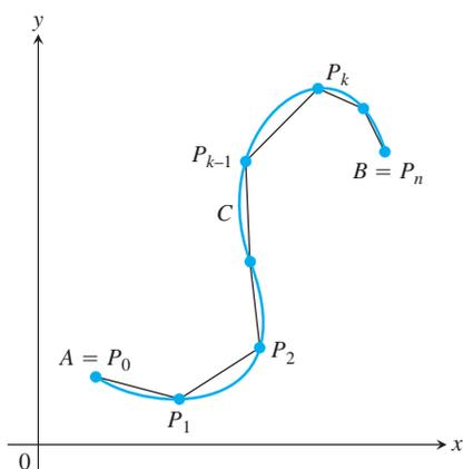
FIGURA 11.14 La curva suave  $C$  definida paramétricamente por las ecuaciones  $x = f(t)$  y  $y = g(t)$ ,  $a \leq t \leq b$ . La longitud de la curva de  $A$  a  $B$  es aproximada por la suma de las longitudes de la trayectoria poligonal (segmentos de línea recta) que inicia en  $A = P_0$ , sigue a  $P_1$  y así sucesivamente, hasta finalizar en  $B = P_n$ .
