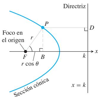
FIGURA 11.48 Si se coloca una sección cónica con su foco en el origen y la directriz perpendicular al rayo inicial y a la derecha del origen, podemos obtener su ecuación polar a partir de la ecuación foco-directriz de la cónica.
