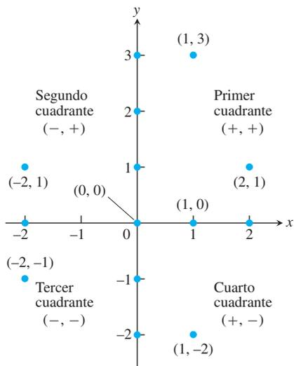
**FIGURA A.5** Puntos etiquetados en el plano de coordenadas  $xy$  o plano cartesiano. Todos los puntos en los ejes tienen un par de coordenadas, pero por lo regular se marcan con un solo número real [por ejemplo,  $(1,0)$  en el eje  $x$  se marca con 1]. Observe los patrones de signos de las coordenadas de los cuadrantes.
