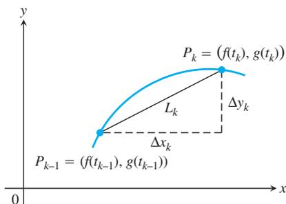
**FIGURA 11.15** El arco  $P_{k-1}P_k$  se aproxima por el segmento de recta que se muestra aquí, con una longitud de
