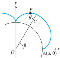
Sea  $b$  el radio del círculo rodante y sea  $A(a, 0)$  la posición inicial del punto  $P$  que traza la curva. Determine las ecuaciones paramétricas de la epicloide, usando como parámetro el ángulo  $\theta$  que forma el eje  $x$  positivo con la recta que pasa por los centros de los círculos.
