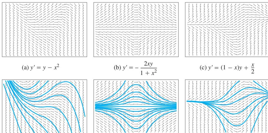
FIGURA 9.3 Campos direccionales (fila superior) y curvas solución seleccionadas (fila inferior). En computadoras, algunas veces los segmentos de pendiente se representan con flechas, como aquí. Sin embargo, no se toma como una indicación de que las pendientes tengan direcciones, porque no es así.
