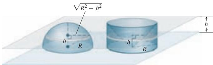
56. **Diseño de una plomada** Se le ha pedido que diseñe una plomada que pese alrededor de 190 g, por lo que decide que la forma debe ser parecida a la del sólido de revolución que se ilustra a continuación. Determine el volumen de la plomada. Si se elige latón, que tiene un peso de  $8.5 \text{ g/cm}^3$ , ¿cuánto pesará la plomada? (Aproxime al gramo más cercano).
