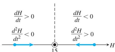
**FIGURA 9.17** La línea de fase completa para la ley de Newton del enfriamiento.
