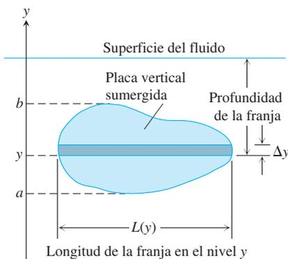
**FIGURA 6.42** La fuerza ejercida por un fluido contra un lado de una franja delgada horizontal es aproximadamente  $\Delta F = \text{presión} \times \text{área} = w \times (\text{profundidad de la franja}) \times L(y) \Delta y$ .
