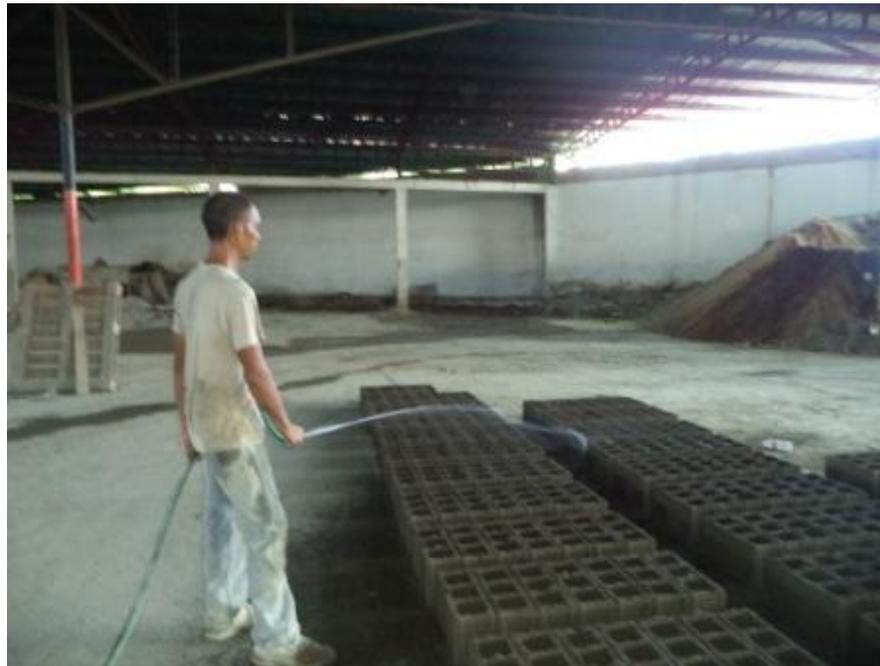
Curado de los bloques duracion del riego 8 min 3 veces al dia para esta blquera.
