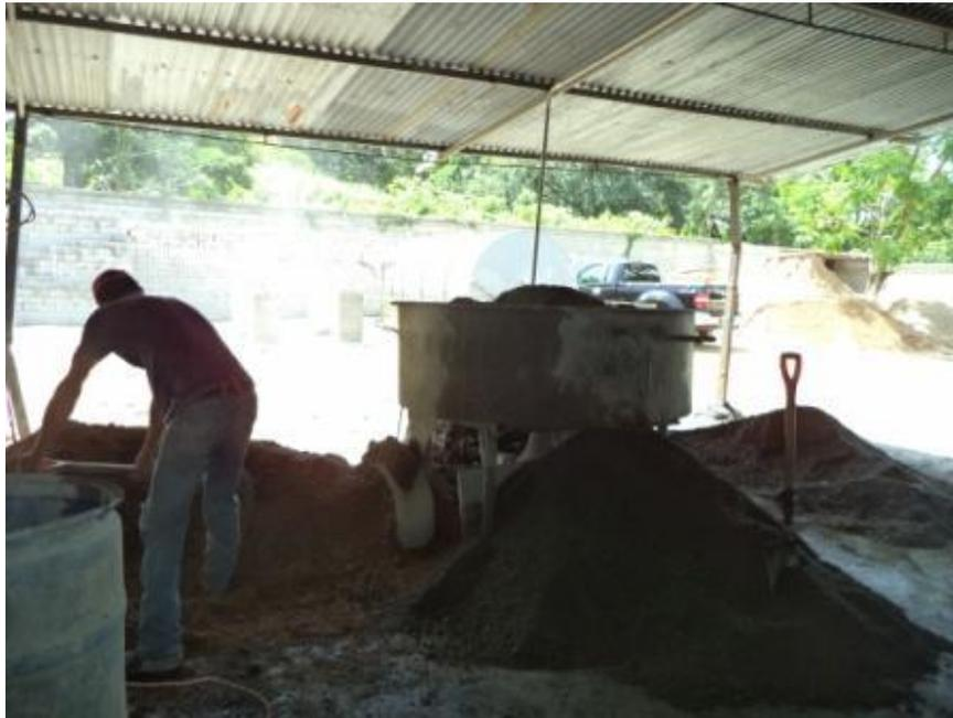
Mezcladora de 7 HP para la preparación de la mezcla para la elaboración de los bloques.
