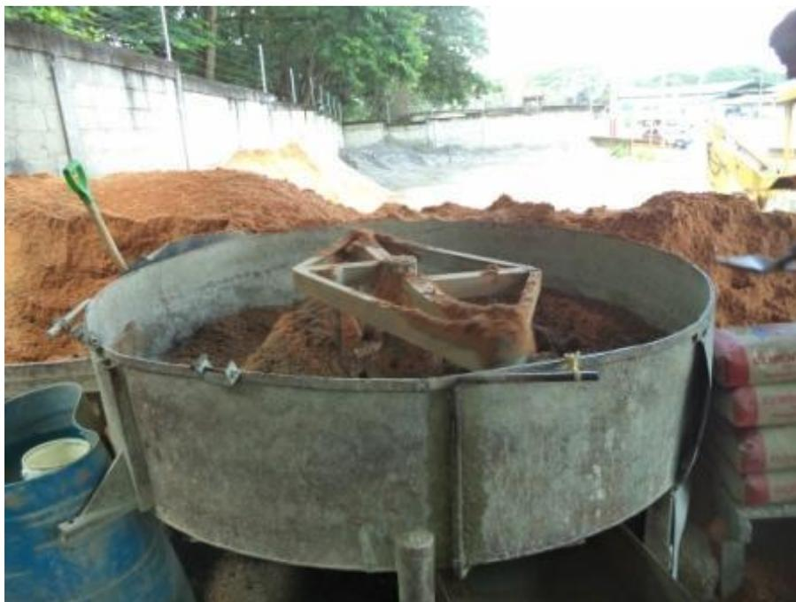
Mezcladora de 5 HP utilizada en la preparacion de la mezcla para la fabricacion del bloque
