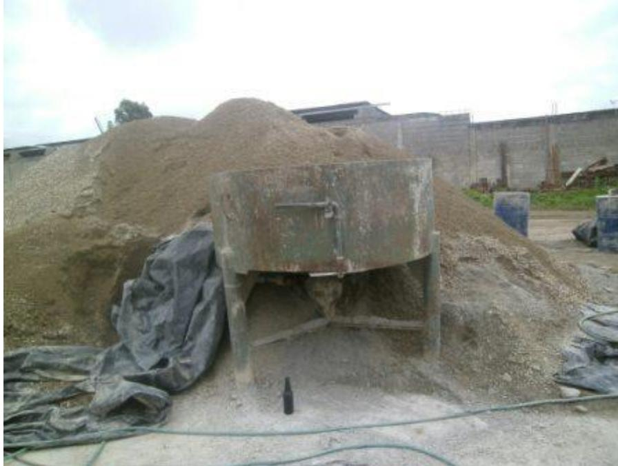
Mezcladora de 7.5 HP utilizada en la preparación de la mezcla para la fabricación del bloque
