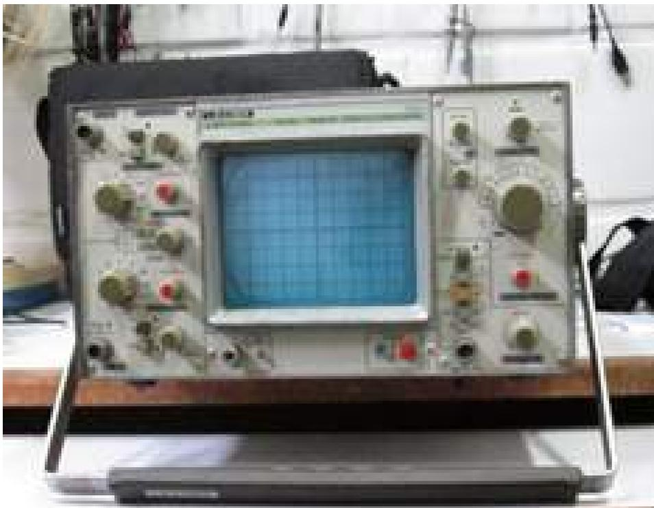
**Figura 79. Osciloscopio Analógico**
