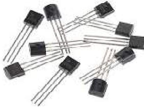
**Figura 260. Transistores con encapsulado plástico**
