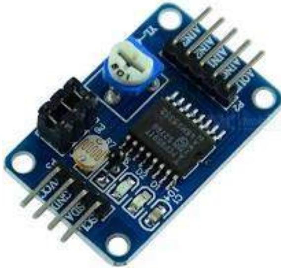
Figura 265. Circuitos integrados conversores ADC y DAC
