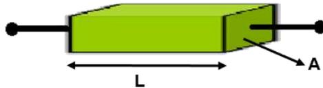
Figura 6. Resistencia eléctrica constructiva
