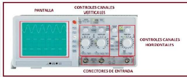
**Figura 97. Partes del Osciloscopio**
