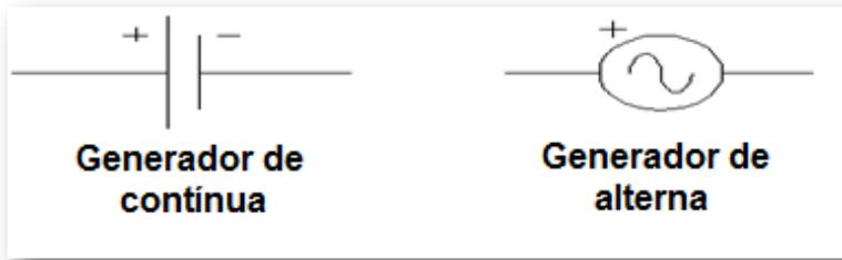
Figura 187. Generador de Continua y de Alterna
