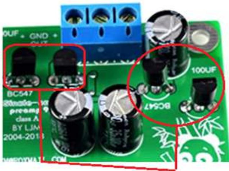
Figura 252. Circuito impreso con transistores
