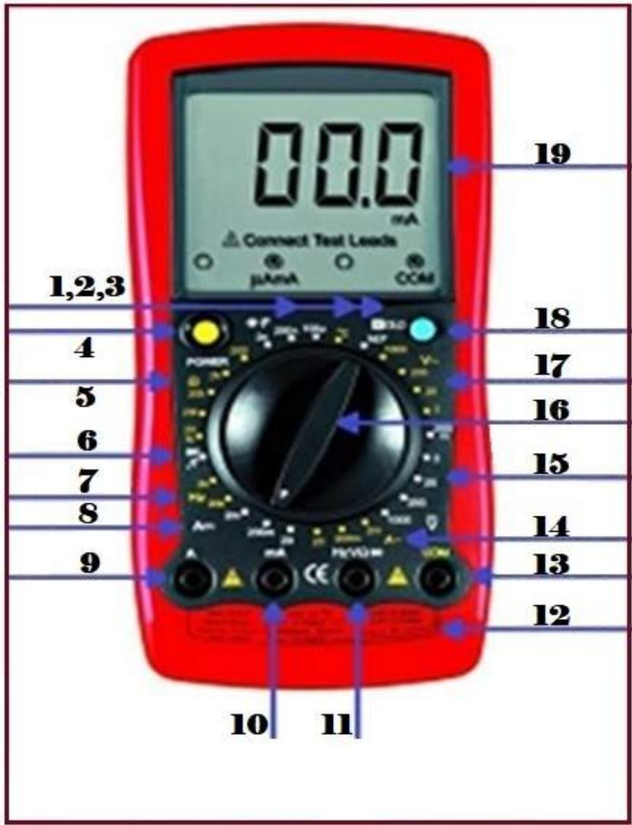
Figura 66. Multímetro digital
