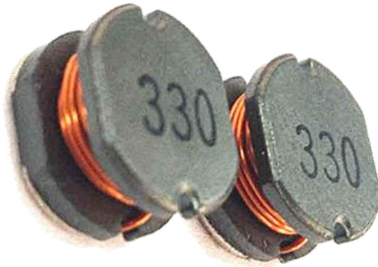
**Figura 224. Código numérico para los inductores ( $330 = 33\mu\text{H}$ )**
