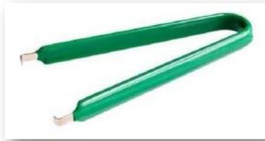
Figura 42. Extractor de circuitos integrados
