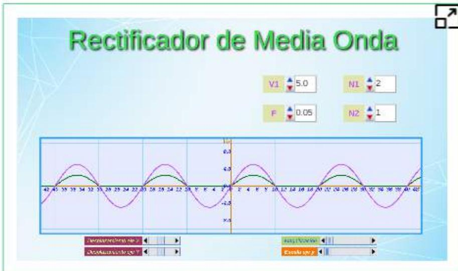
La señal de color **fucsia** es  $V_1$  y la señal de color **verde** es la rectificada  $V_O$  que es igual al voltaje en  $R_L$  (Resistencia de Carga - Load Resistor)
