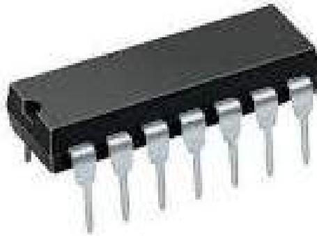
Figura 264. Circuito Integrado Monolítico
