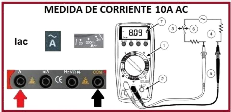
Figura 72. Medida de Corriente 10A AC
