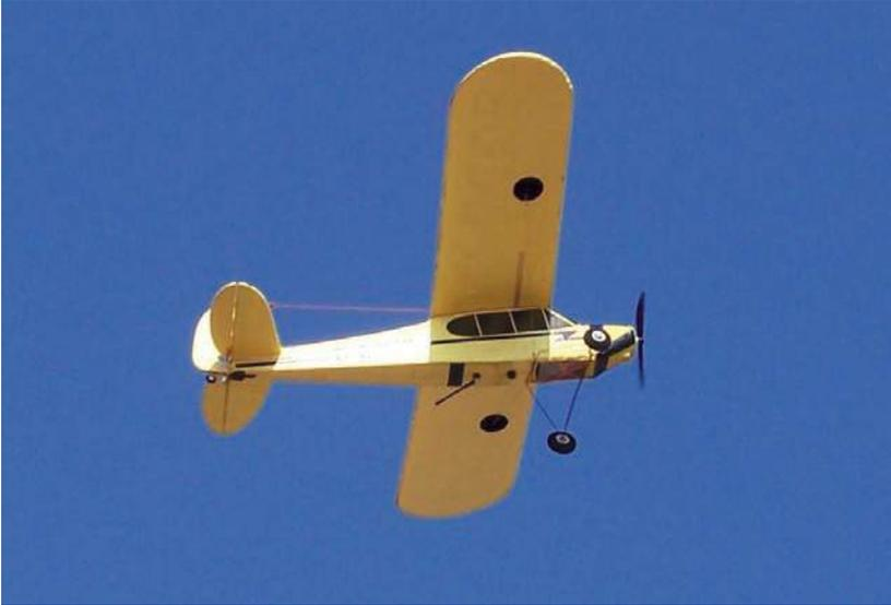
Figura 15. Avión con cámara incorporanda volando sobre parcela de muestreo
