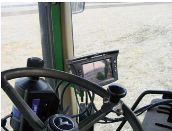
Figura 26. Sistema de guiado automático móvil “EZSteer” acoplado al volante del tractor
