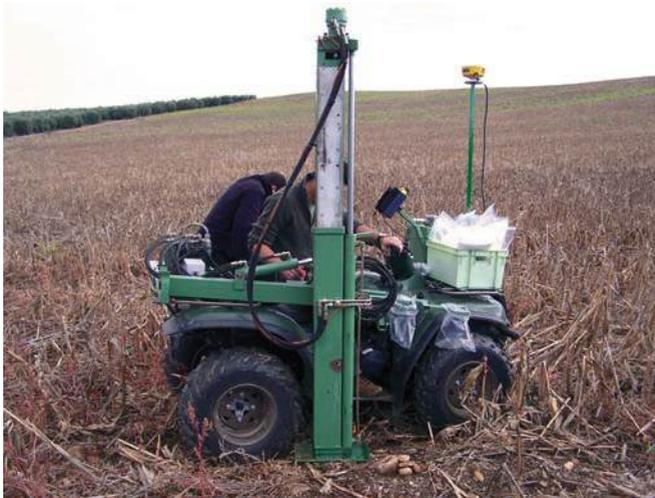
Figura 9. Quad preparado para muestrear suelo
