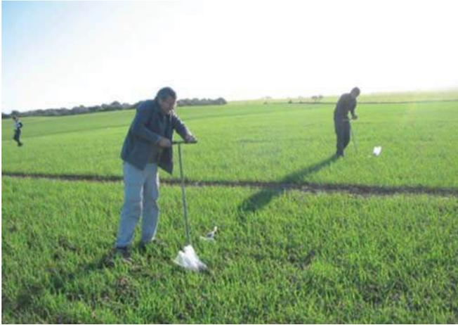
Figura 8. Muestras simultáneas con barrena para caracterizar una parcela experimental
