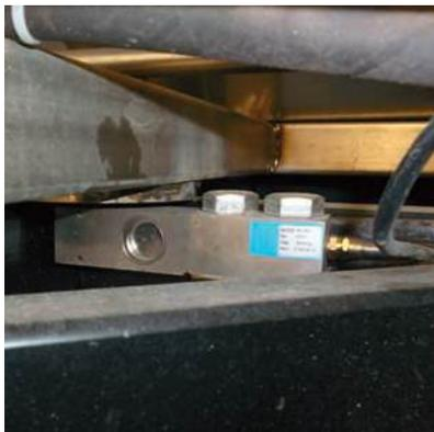
Figura 23. Célula de carga instalada en abonadora.
