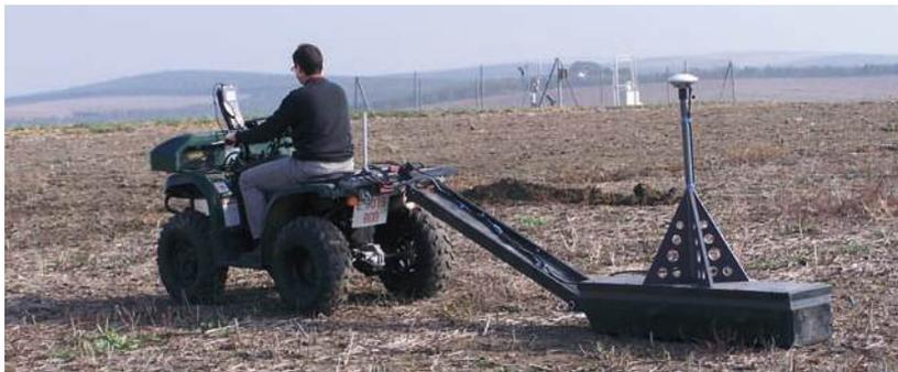
Figura 11 Sonda EM38 arrastrada por quad.
