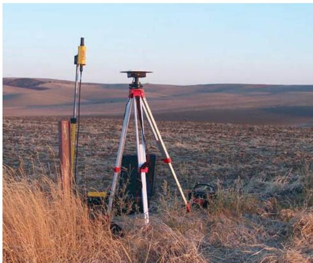
Figura 6. Estacion base para correcciones RTK
