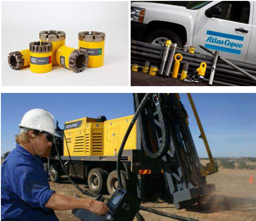
Arriba, herramientas de corte y varillas. Abajo, perforación profunda para exploración mediante aire reverso (imágenes 4 ).
