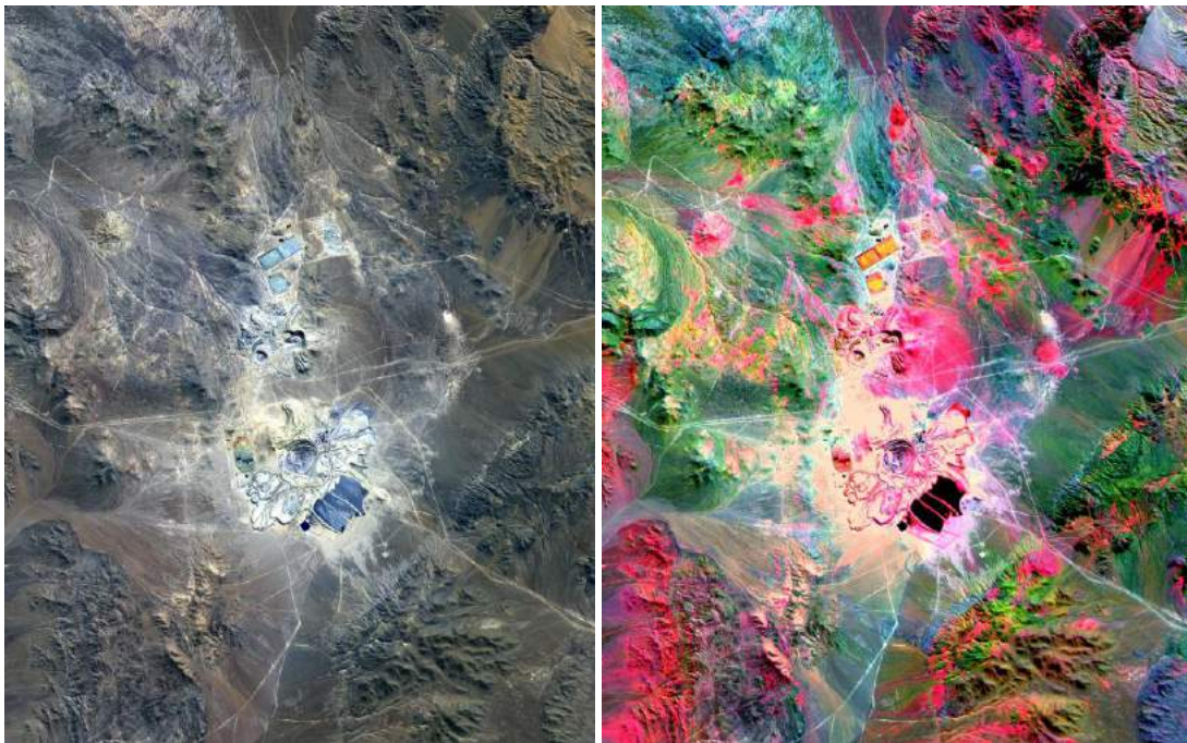
Imágenes ASTER de la mina de cobre La Escondida (Chile). Las imágenes cubren 30 x 37 km en el desierto de Atacama y tiene fecha 23 de Abril de 2000. La mina está a una altitud de 3050 m y entró en funcionamiento en 1990. Izquierda, imagen VNIR; a la derecha, imagen SWIR. Note los importantes contrastes de colores que se pueden apreciar en la imagen SWIR, con potenciales aplicaciones geológicas y minero-ambientales. NASA Visible Earth (2008).
