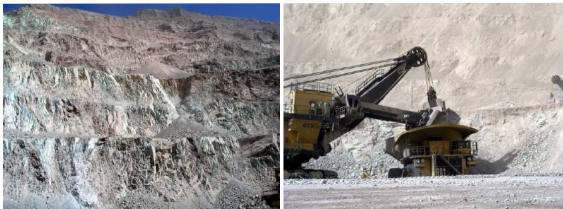
A la izquierda los bancos, donde se pueden apreciar colores verdes y rojizos que representan a los oxidados de cobre y hierro; a la derecha, operación de carga de uno de los grandes camiones. Mayo de 2006.
