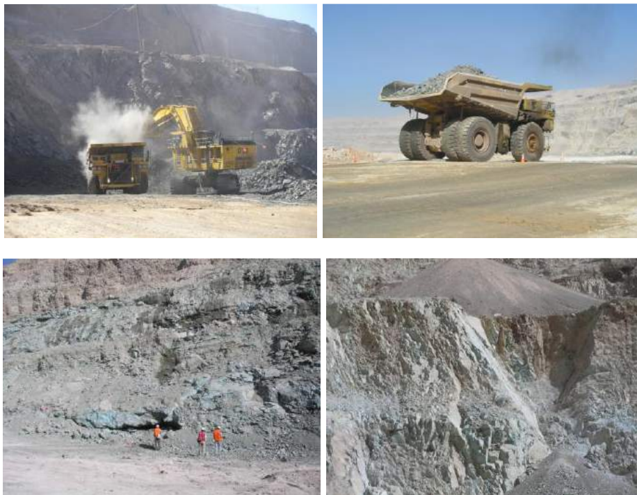
Arriba, bancos de trabajo en Mina Sur (Distrito Minero de Chuquicamata), abajo izquierda, Mina Sur y a la derecha RT (mismo distrito). No hay nada que cartografiar en el piso de los bancos, pero mucho que hacer en los frentes de los mismos (imágenes inferiores).
