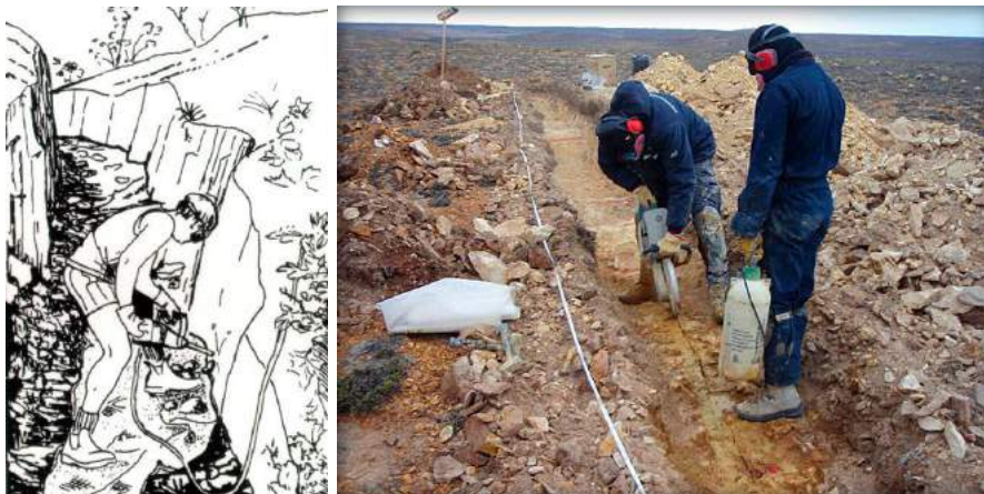
Toma de muestras en roza continua ( channel samplig ). A la izquierda con martillo neumático (Marjoribanks, 1997); a la derecha, uso de una sierra de cortar roca (imagen 3 ).
