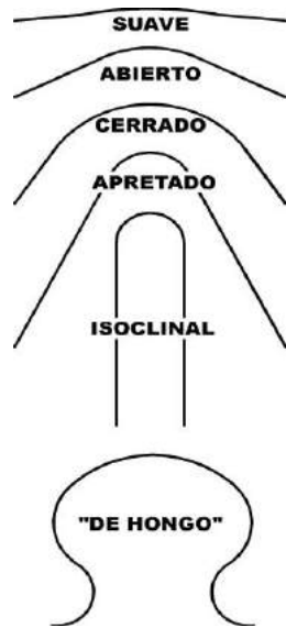
FIGURA 5.11.- Nomenclatura de un pliegue según la intensidad de su ángulo interlimbos (AI). Suave (AI de 120° a 179°), abierto (AI de 70° a 119°), cerrado (AI de 30° a 69°), apretado (AI de 1° a 29°), isoclinal (AI = 0°) y “ de hongo ” (AI = ángulos negativos).
