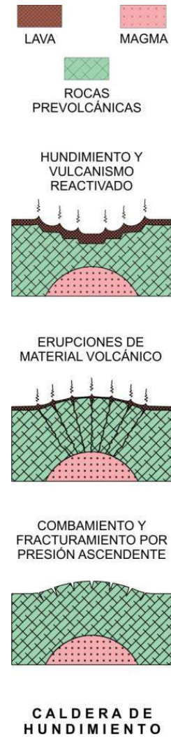
FIGURA 12.9.- Evolución geológica de una caldera de hundimiento.
