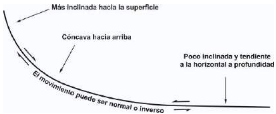
FIGURA 4.14.- Características de una falla lístrica. Observe que el término se aplica tanto a una falla de tipo normal, como a una de tipo inverso.
