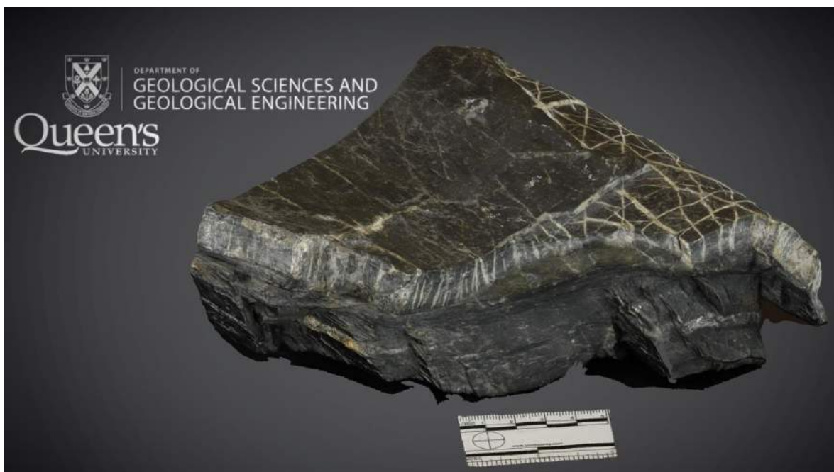
FIGURA 6.14. Fracturas en pliegue de caliza. Localidad desconocida. https://sketchfab.com/3d-models/s0056-d04e7e3bc7f34adea7cab9128f7b37cb . Accesada el 21 de diciembre del 2020.
