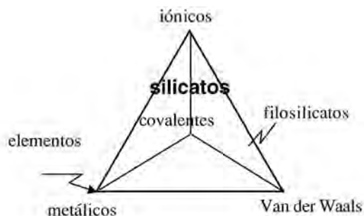
Figura 63. Representación esquemática de Correns de los cuatro tipo de enlaces
