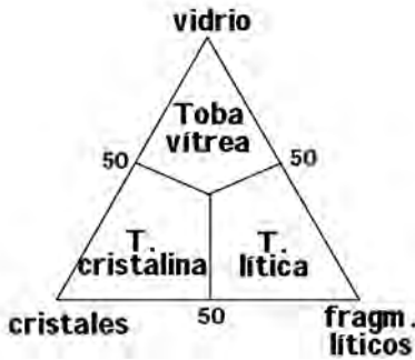
Figura 130. Diagrama triangular de composición de las tobas.
