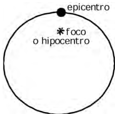
Figura 8. Esquema de la Tierra con la ubicación del foco del terremoto y el epicentro del mismo.
