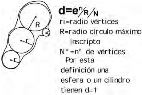
Figura 118. Esquema que representa un clasto sobre el cual se han practicado las mediciones correspondientes de redondez.
