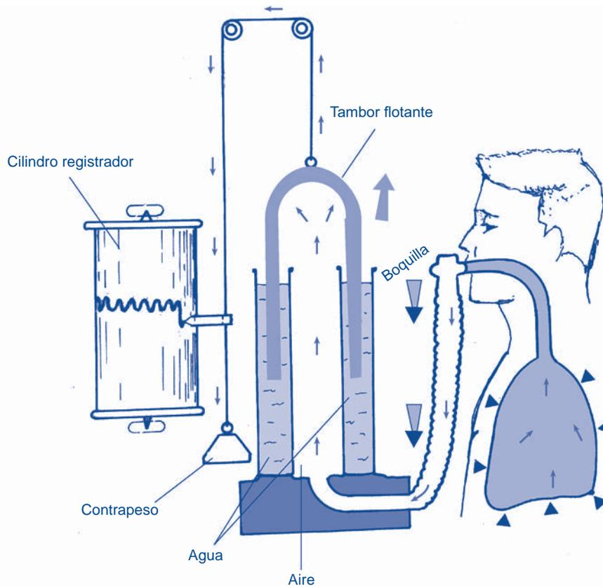
**Figura 7.14.** Espirómetro. El sujeto respira por una boquilla conectada a una cámara de aire en forma de u invertida, ésta hace que el tambor flotante suba o baje durante la espiración o inspiración. Los movimientos del tambor se van marcando en el cilindro registrador que está girando.
