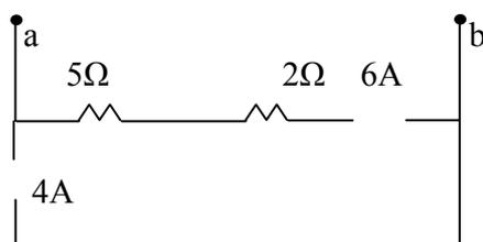
Figura 2.22 Circuito del Problema 2.9 Cálculo de  $R_{th}$
