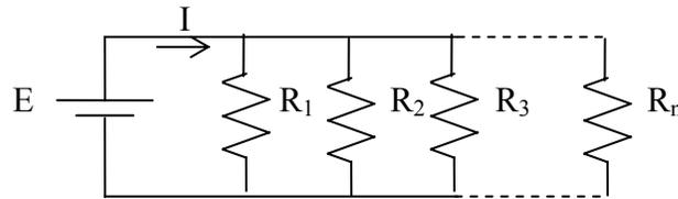
Figura 2.10 Problema 2.6. Circuito paralelo (Divisores de Corriente)
