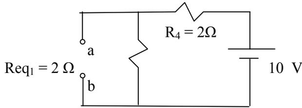
Figura 2.14 Problema 2.7. Circuito equivalente, sin fuente de corriente.
