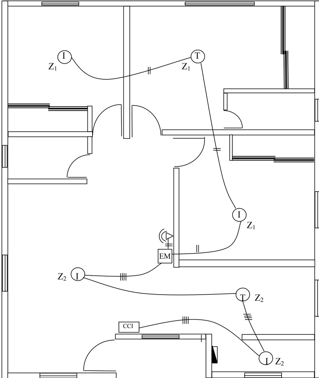
Figura 5.5 Sistema de Detección y Alarma Contra Incendio
