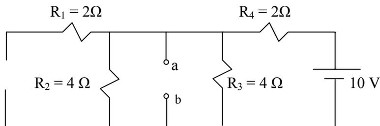
Figura 2.13 Problema 2.7 . Teorema de Superposición. Eliminando la fuente de corriente.
