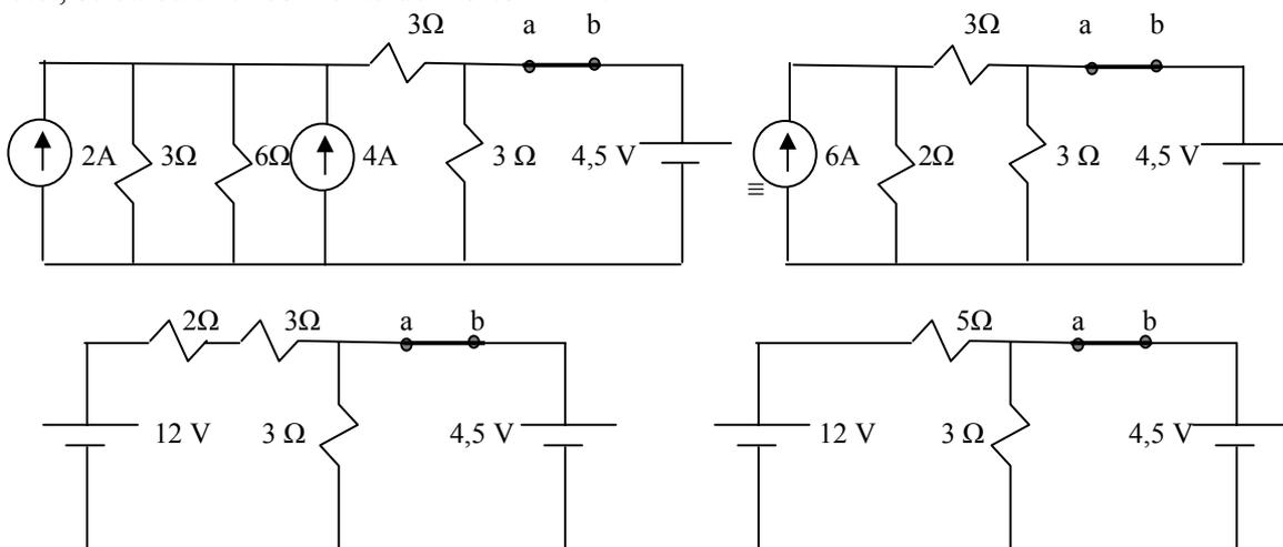
Figura 2.27 Circuitos equivalentes del Problema 2.10. Cálculo de  $I_n$ .
