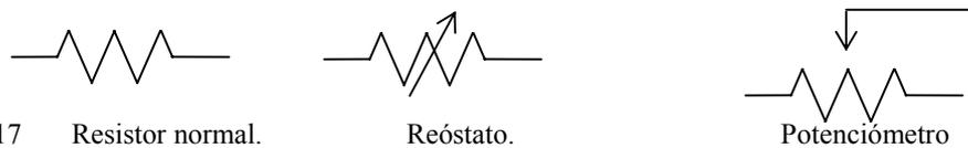
Figura 1.17 Resistor normal.
