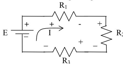
Figura 2.1 Circuito para aplicar la Ley Kirchhoff de Voltaje
