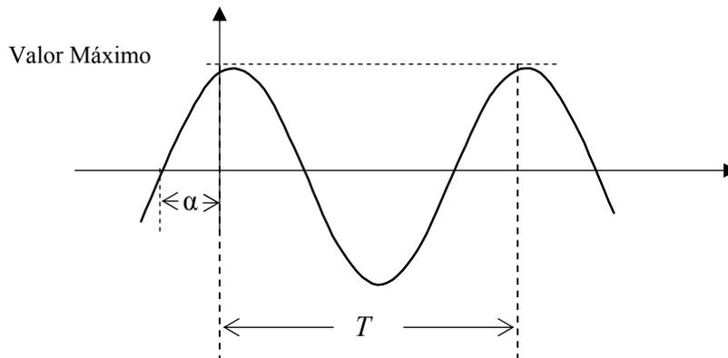
Figura 3.2 Onda Senoidal.
