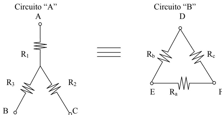
Figura 2.8 Circuitos equivalentes Estrella - Delta.
