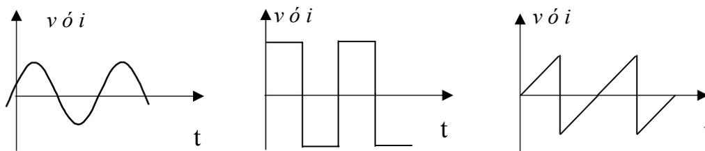
Figura 3.1 Formas de Onda: Senoidal, Cuadrada y Rampa.
