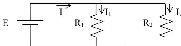
Figura 2.11 Problema 2.6. Circuito paralelo con resistores.
