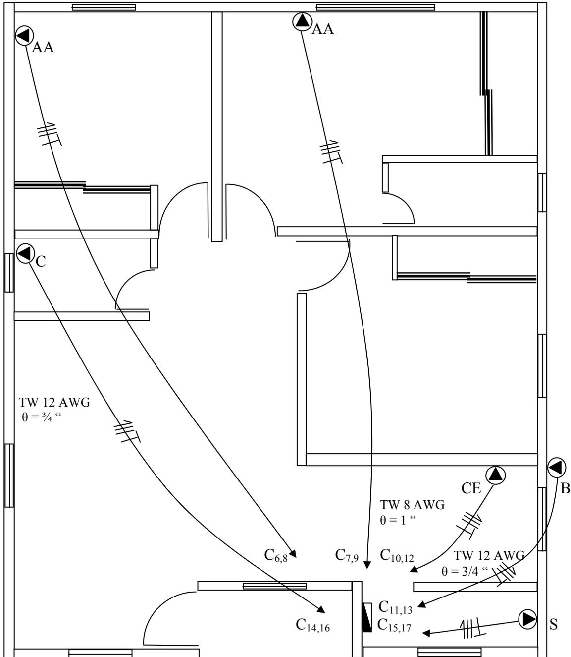
Figura 5.3 Circuitos de Tomacorrientes Especiales.
