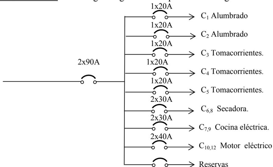
Figura 5.14 Diagrama unifilar del Tablero.
