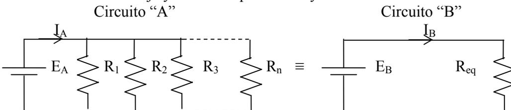
Figura 2.7 Problema 2.4. Circuitos equivalentes paralelos.
