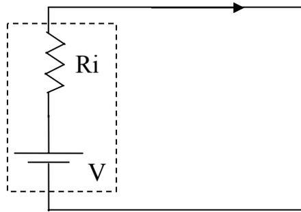
Figura 1.11 Fuente de Voltaje Real.
