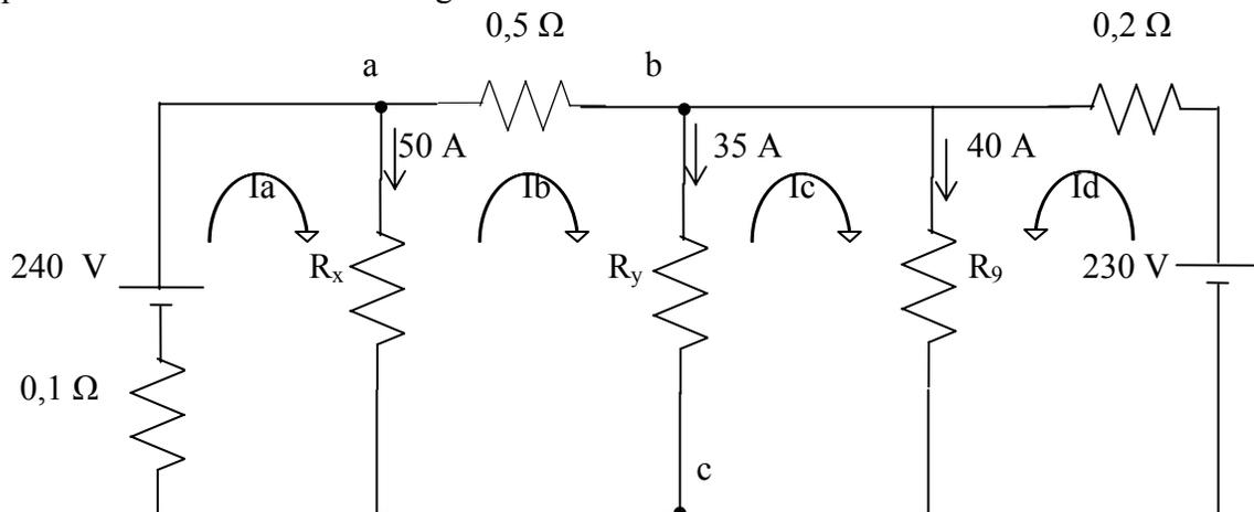
Figura 2.130 Problema 2.55 Método de Mallas Circuito equivalente.
