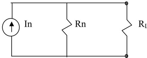
Figura 2.24 Circuito equivalente de Norton.
