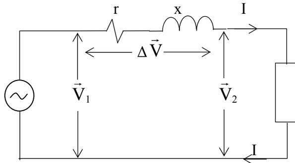
Figura 5.9 Circuito equivalente de una fase en sistemas trifásicos.
