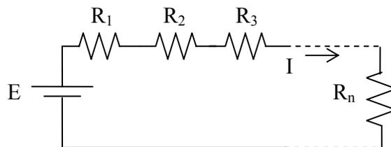
Figura 2.9 Problema 2.5. Circuito serie (Divisores de Voltaje)
