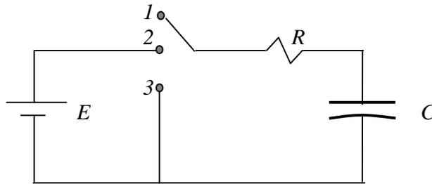
Figura 2.45 Problema 2.22 Circuito RC en carga
