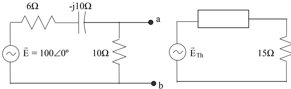
Figura 3.67 Problema 3.56 Circuito equivalente en corriente alterna.
