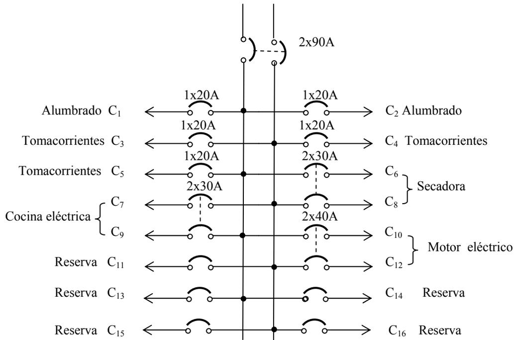
Figura 5.15 Diagrama del Tablero.
