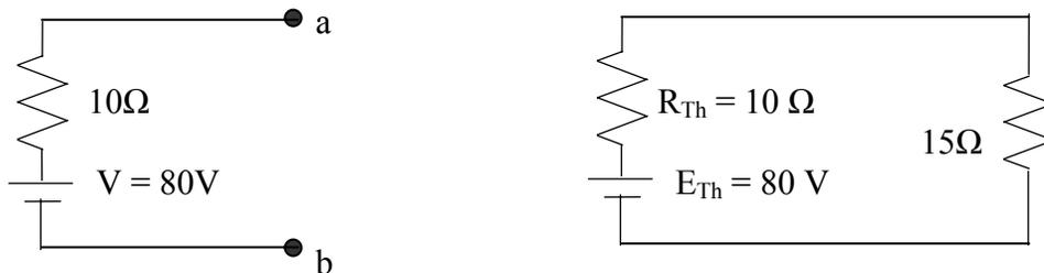
Figura 3.68 Problema 3.56 Circuito equivalente en corriente continua.
