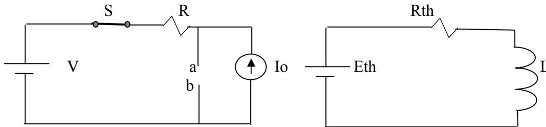
Figura 2.139 Problema 2.61 Circuito RL. Circuito equivalente de Thévenin
