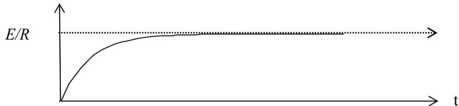
Figura 2.43 Problema 2.20. Gráfica de la corriente en un Inductor en carga
