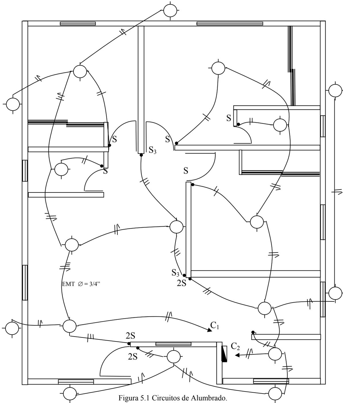
Nota: Salvo que se indique lo contrario la tubería será EMT  $\varnothing = 1/2"$  y el cable TW 12 AWG.
