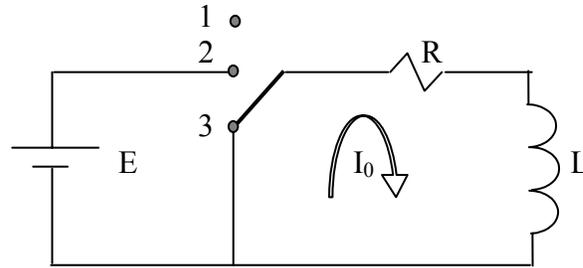
Figura 2.44 Problema 2.21 Circuito RL en descarga
