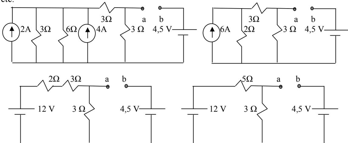
Figura 2.20 Circuitos equivalentes del Problema 2.8. Cálculo de Eth
