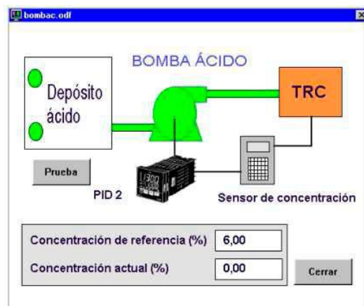
Figura 7.17: Ventana de estado de la bomba dosificadora de ácido.
