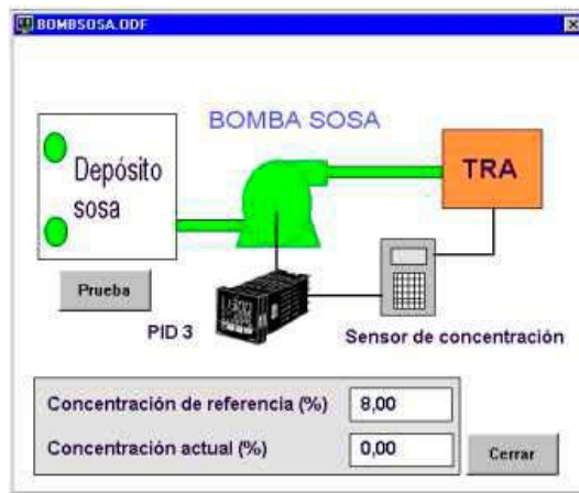
Figura 7.18: Ventana de estado de la bomba dosificadora de sosa.
