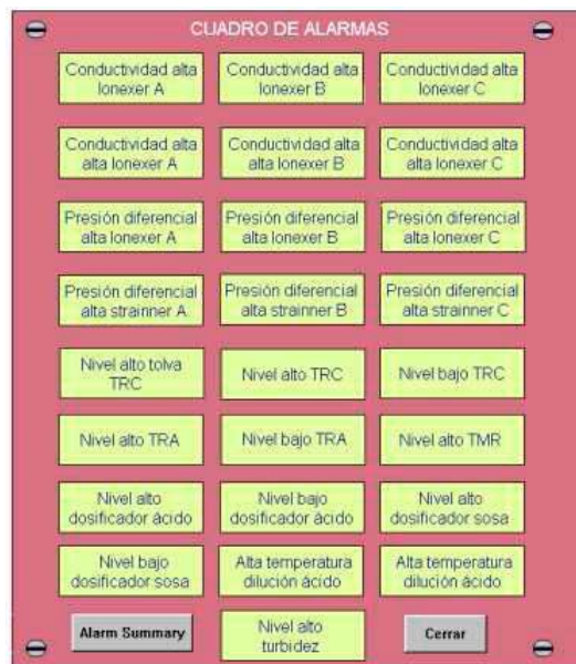
Figura 7.19: Ventana de alarmas.
