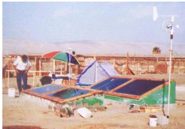
Figura 1.5.2 Destilador de bandejas
