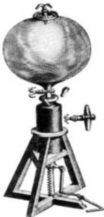
Fig. 84. Máquina de vacío de Boyle.
