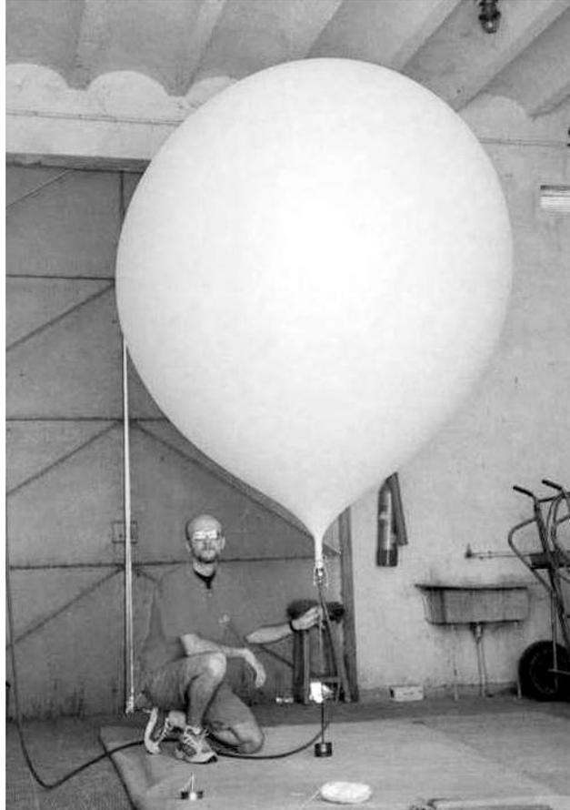
nutos, que es el tiempo máximo que debe durar un radiosondeo, se estima que se requiere de un globo meteorológico de 800 gramos de peso y un diámetro de 160 centímetros (no inflado), capaz de levantar hasta 450 gramos (incluido el peso de la sonda) a una velocidad promedio de 5 metros por segundo.
