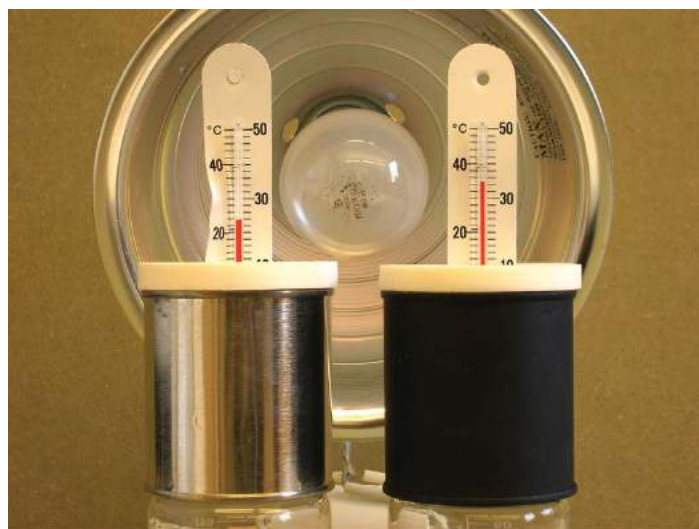
Figura 4.1. Materiales para la Actividad 4.1. Los termómetros muestran la diferencia en temperatura entre la lata negra y la lata brillante después de haber sido expuestas a una fuente de luz.
