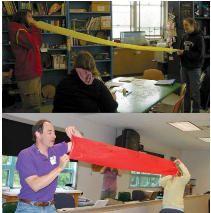
Figura 2.7. (superior) Un estudiante intentando llenar la bolsa mientras la tiene pegada a sus labios (inferior) Cuando se mantiene la bolsa completamente abierta y se sopla desde una distancia hacia la apertura, la bolsa puede llenarse con un solo soplo.
