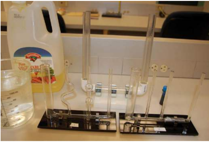
Figura 2.4. Materiales usados en la Actividad 2.4. El manómetro en forma de U (Parte A) se ve al fondo. En la parte delantera se ve el tubo de equilibrio con brazos de diferentes formas (izquierda) y el tubo de equilibrio con brazos de diferentes diámetros (derecha).
