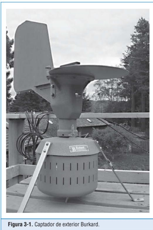
Figura 3-1. Captador de exterior Burkard.
