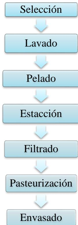
**Figura 2.** Esquema tecnológico para la obtención del zumo de mandarina (*Citrus reticulata*).
