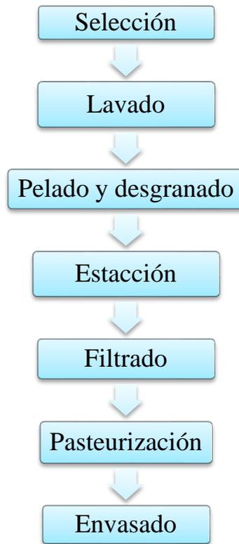
**Figura 3.** Esquema tecnológico para la obtención del zumo de granada.
