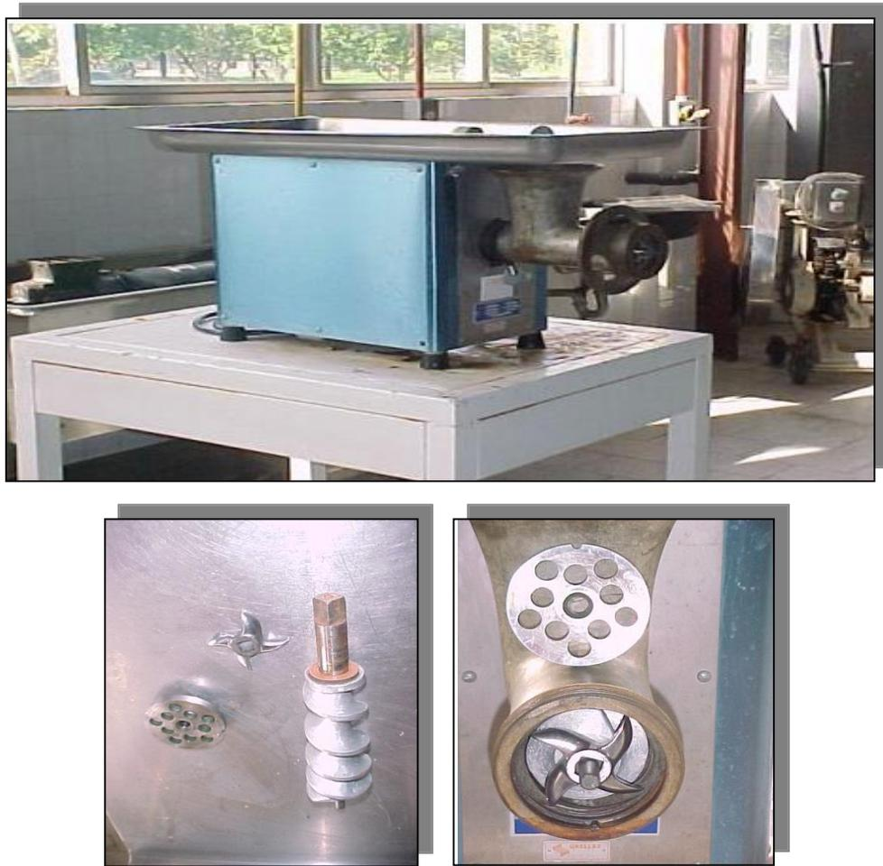
Figura 35. Molino para carne con diámetro de salida de 5 mm
