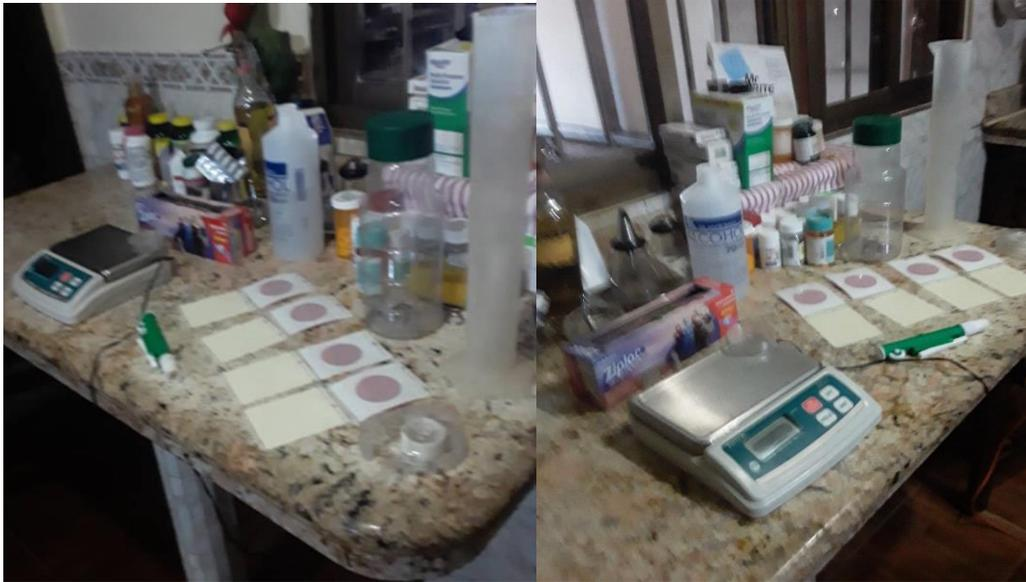
Figura 39. Uso de Petrifilm para la determinación de aerobios y coliformes
