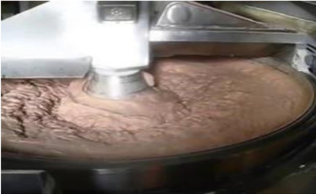
Figura 27. Cùtter o cortadora. Efecto de cortado/mezclado/emulsificado
