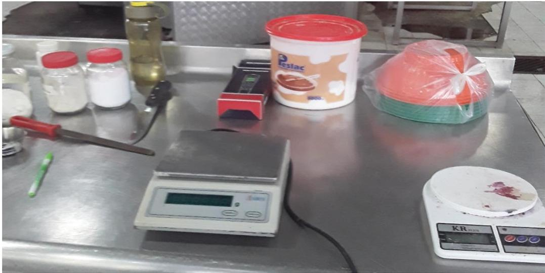
Figura 22. Balanza digital marca Denver Instrument, modelo XL-6100
