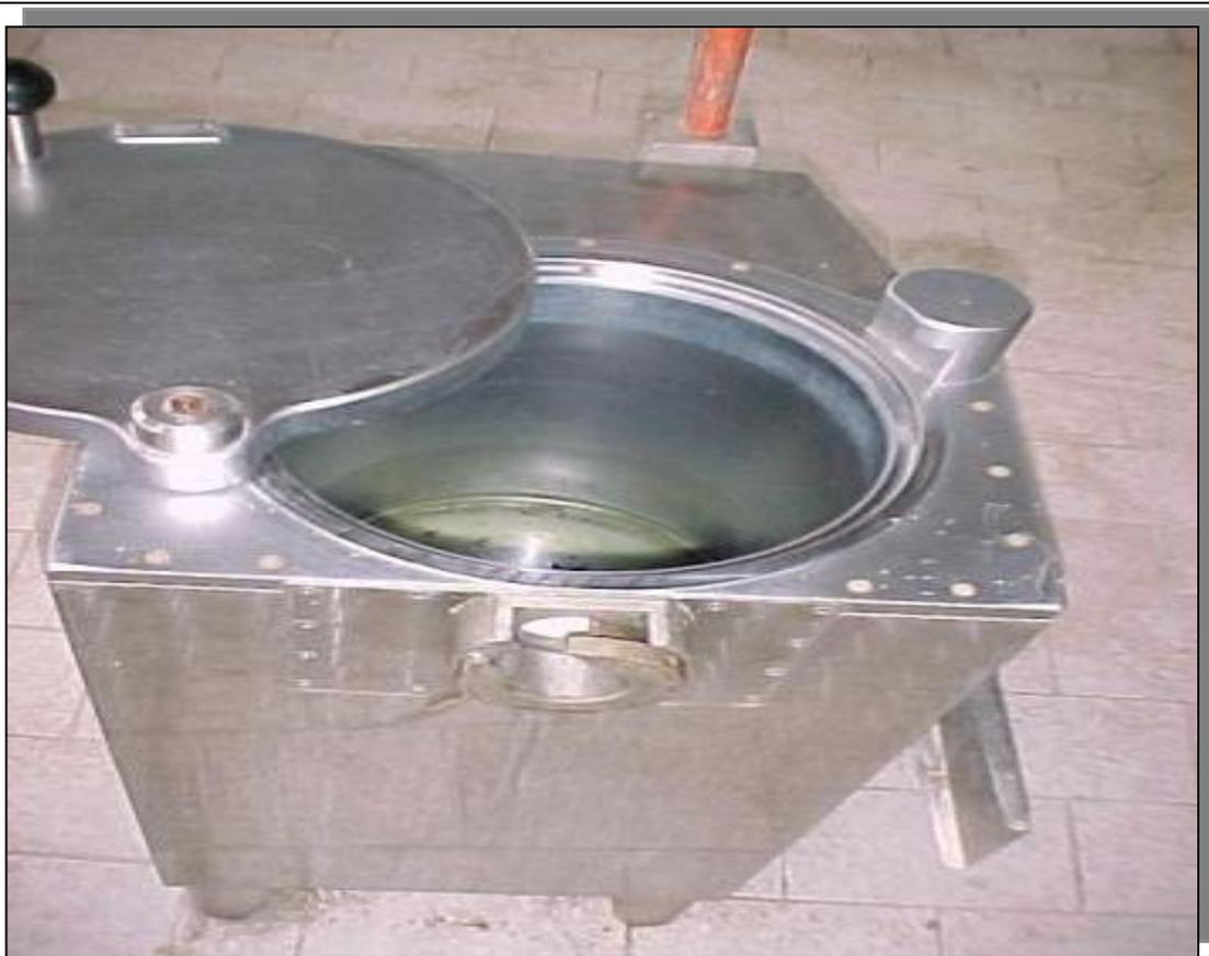
Figura 31. Embutidora tipo pistón, capacidad 18kg
