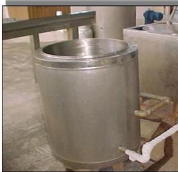
Figura 32. Tanque de acero inoxidable de doble camisa, con inyección de vapor
