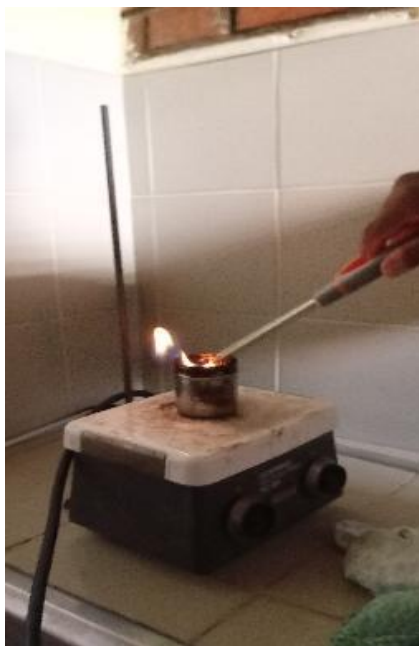
Figura 6: Flash Point para Muestra X79
