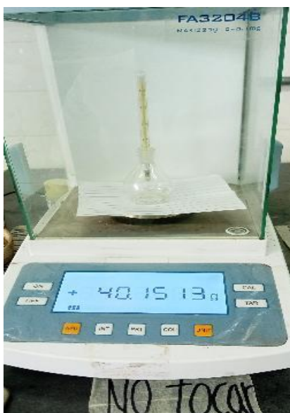
Figura 15: Medición de Picnómetro Vacío y Lleno Después de Desgasificar Muestra X92
