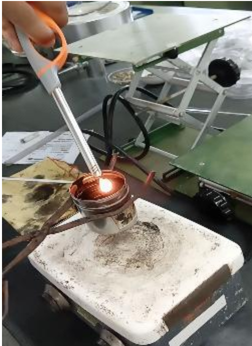
Figura13: Flash Point Muestra X79 después de desgasificar, No hubo Inflamación
