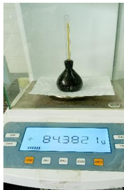
Figura 15: Medición de Picnómetro Vacío y Lleno Después de Desgasificar Muestra X92
