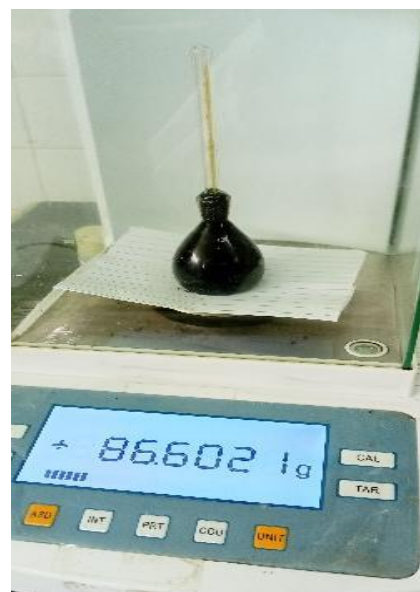
Figura 16: Medición de Picnómetro Vacío y Lleno Después de Desgasificar Muestra X79
