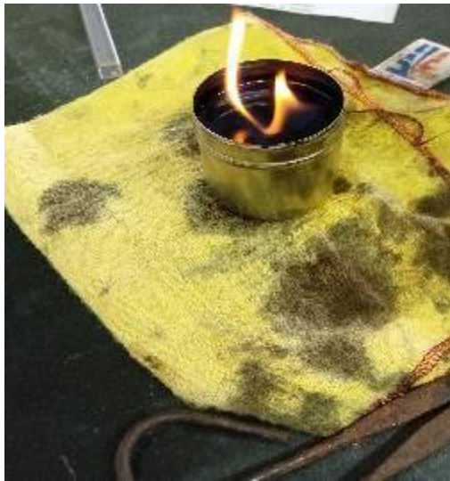
Figura 11: Flash Point Muestra después de desgasificar
