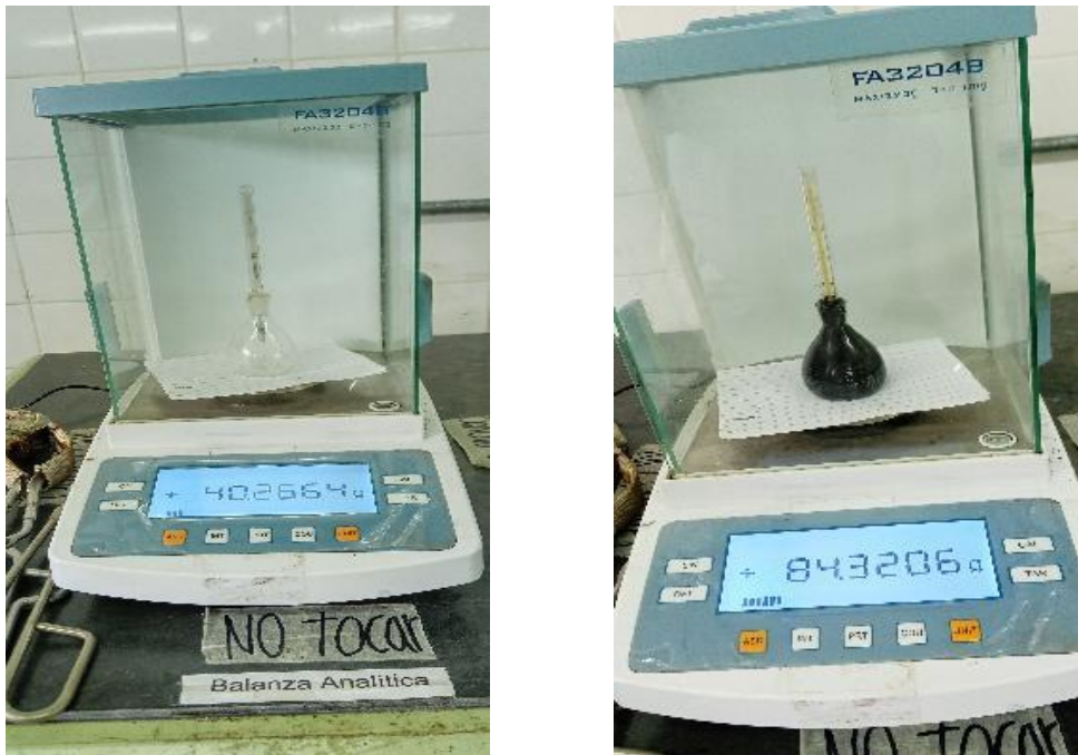
Figura 5: Medición Picnómetro Vacío para la muestra X92
