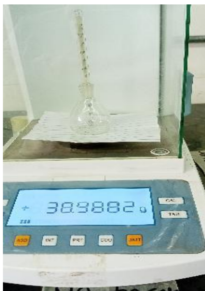
Figura 16: Medición de Picnómetro Vacío y Lleno Después de Desgasificar Muestra X79
