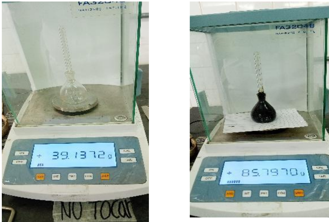
Figura 4: Medición de Picnómetro Vacío y Lleno para Muestra X79
