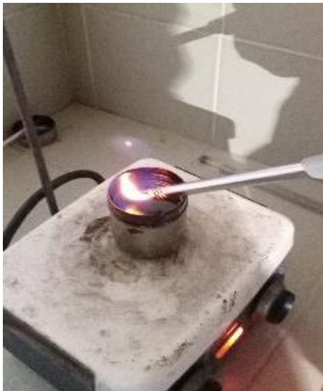
Figura 8: Flash Point para Muestra X92
