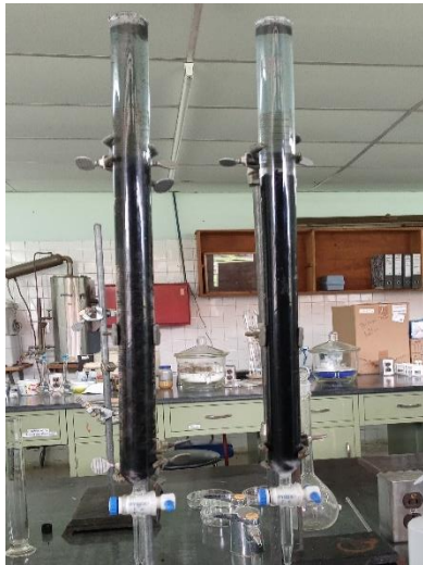
Figura: N° 33 Columnas de filtración
