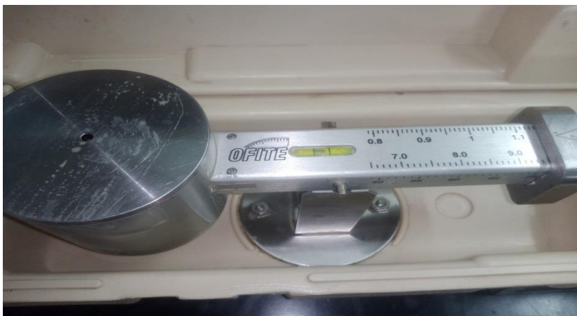
Figura 14. Determinación de la densidad.
