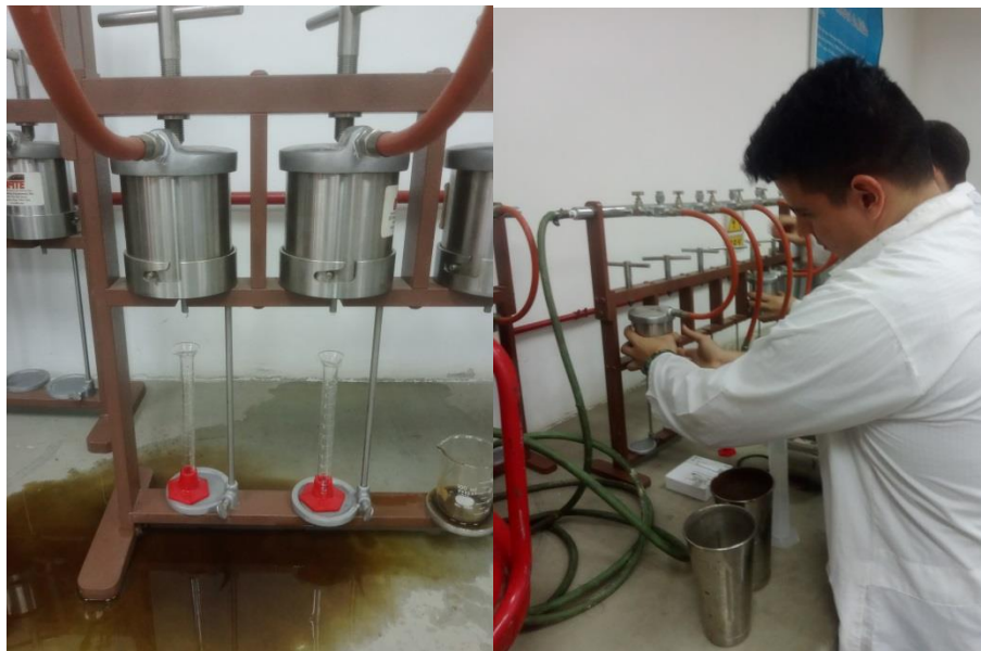
Figura 18. Medición de la prueba de filtrado en el filtro prensa.
