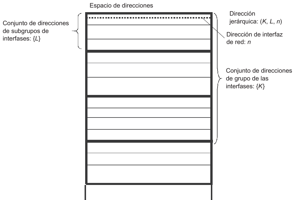
FIGURA 2.11 Estructura jerárquica del espacio de direcciones.
