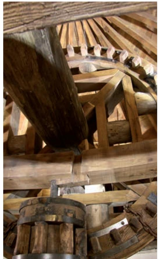
Mecanismo de un molino de viento: eje, rueda catalina y linterna
