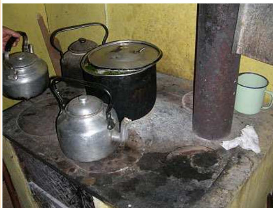
Cocina a leña realizada en hierro y ladrillos, utilizada por algunos habitantes del sur de Chile.
