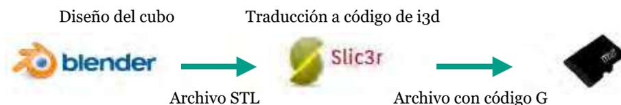
Imagen 7. Pasos para la traducción de un diseño 3D en órdenes de fabricación
