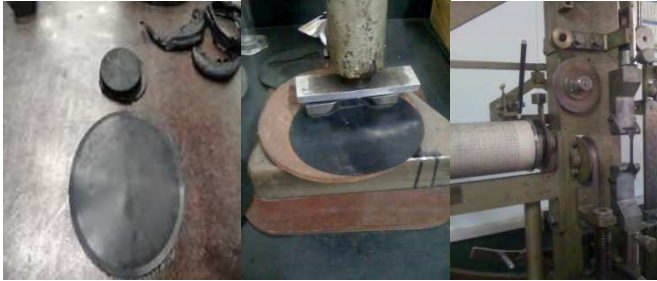
Figura 3: Probetas y ensayos de dureza, tracción y compresión en el material base.
