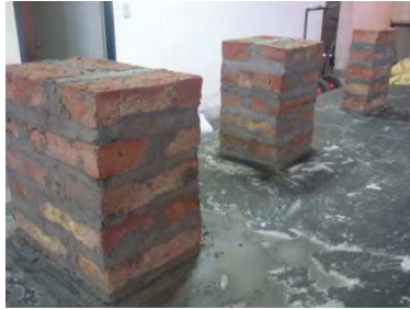
Figura 4: Pilas de Mampostería en Laboratorio
