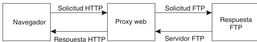
Figura 12-6. Utilización de un proxy web cuando el navegador no habla FTP.
