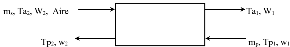
Fig. 4.15. Balance de materia y energía para un proceso de secado en contracorriente.
