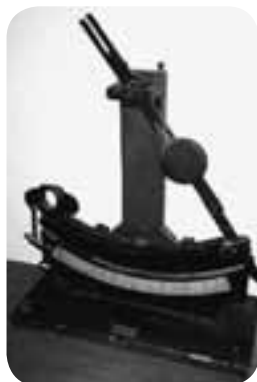
Figura 3.1 Aparato utilizado a principios del siglo XX para medir el tiempo de reacción ante estímulos.
