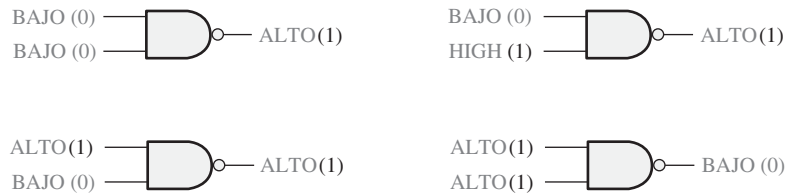
FIGURA 3.26 Funcionamiento de la puerta NAND de 2 entradas.
