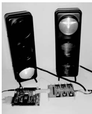
Tarjeta de desarrollo que contiene el CPLD programado y una tarjeta de interfaz que controla en el laboratorio los semáforos del modelo. Cortesía de Dave Buchla.
