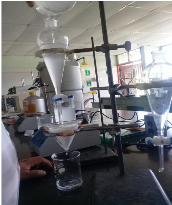
Figura 7. Montaje experimental para la separación líquido
