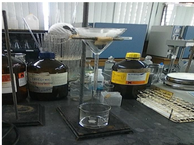
Figura N° 14. Lavado del carbón activado a partir de la cáscara de coco con agua destilada.
