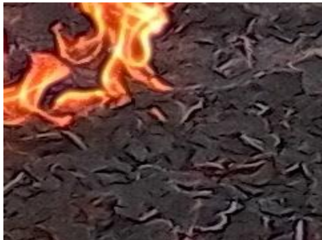
Figura N° 12. Proceso de Carbonización de la cáscara de coco.
