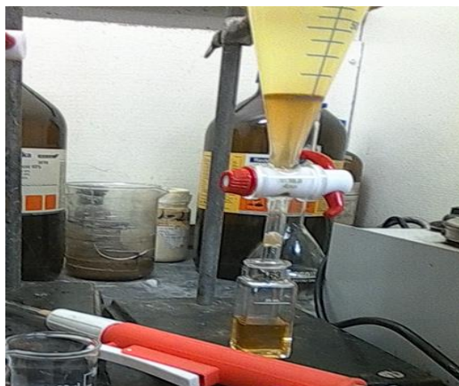
Figura N° 26. Toma de muestra del blanco en celda de 25ml
