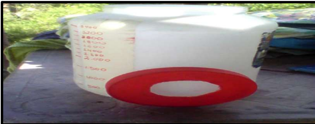
Figura 18. Envase calibrado con un agujero en la tapa para evitar que el fenol fuera volatilizado
