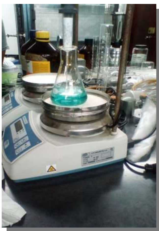
Determinación de Parámetros Químicos: Alcalinidad y Dureza de Muestra (Gutiérrez y Velásquez 2018)
