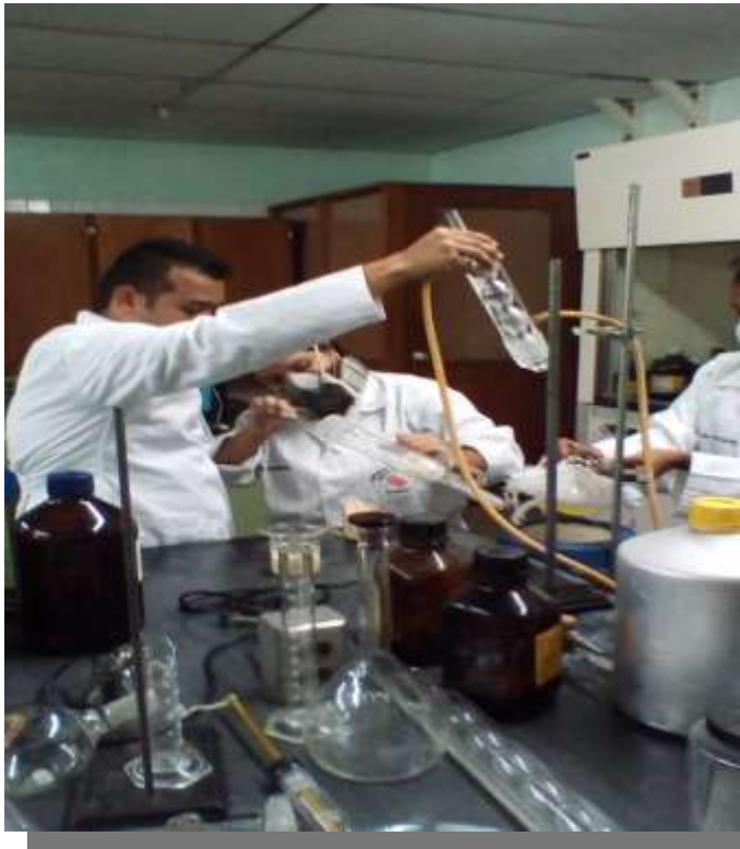
Método de Extracción Continuo con soxleth (Gutiérrez y Velásquez 2018)
