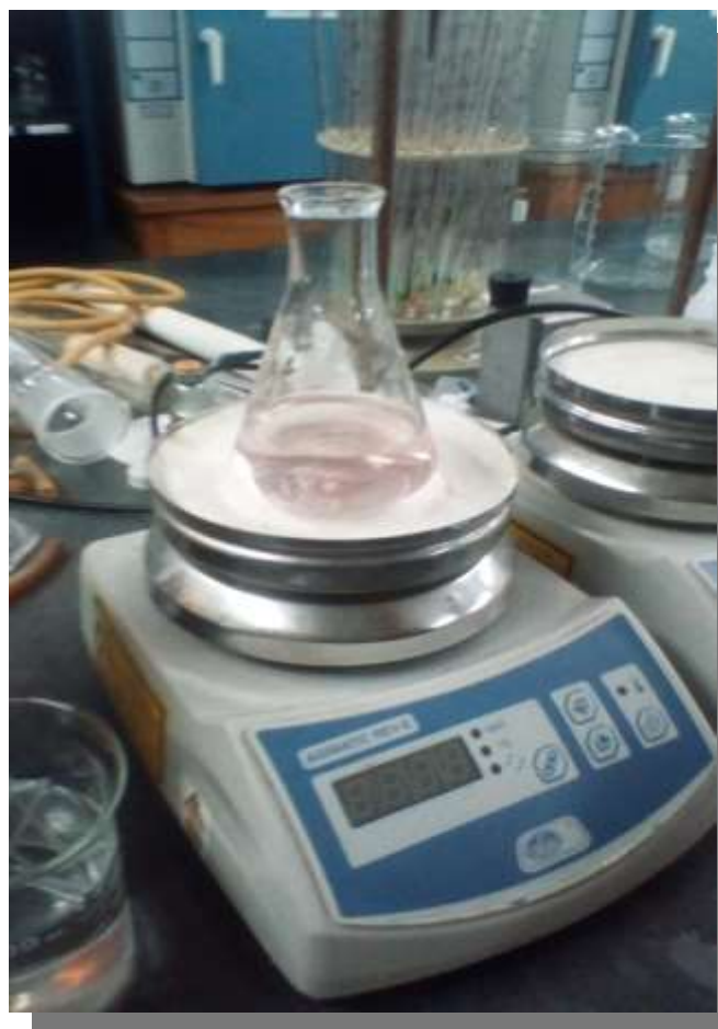
Determinación de Parámetros Químicos: Alcalinidad y Dureza de Muestra (Gutiérrez y Velásquez 2018)
