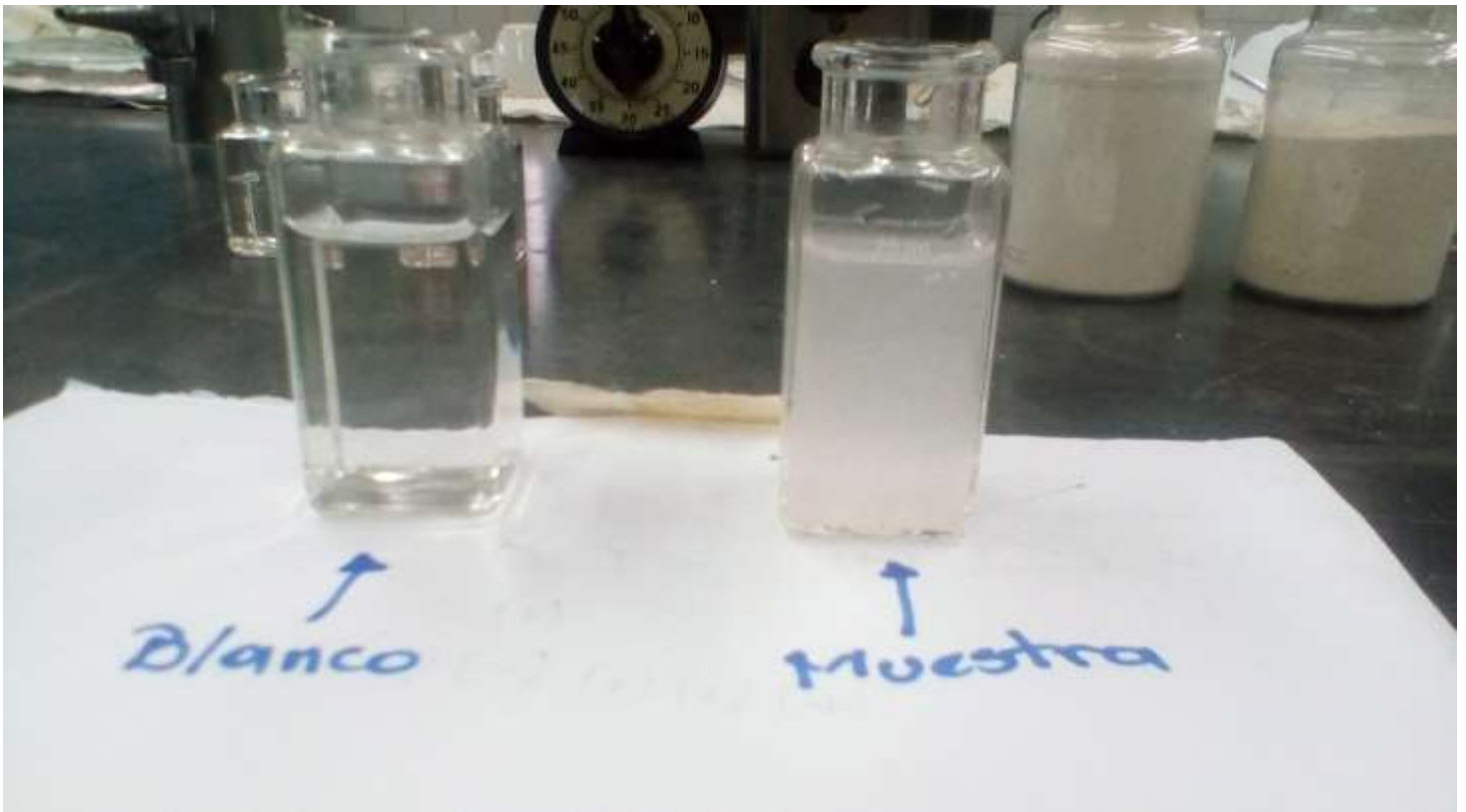
Determinación de Parámetros Físicos y Químicos: Color Real Color Aparente y Solidos Suspendido (Gutiérrez y Velásquez 2018)
