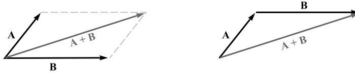
Figura 1.1 Dos vectores pueden sumarse gráficamente dibujándolos desde un origen común y completando el paralelogramo o haciendo que el segundo vector comience en la punta del primero y completando el triángulo; cada uno de estos métodos es fácilmente generalizado para el caso de tres o más vectores.
