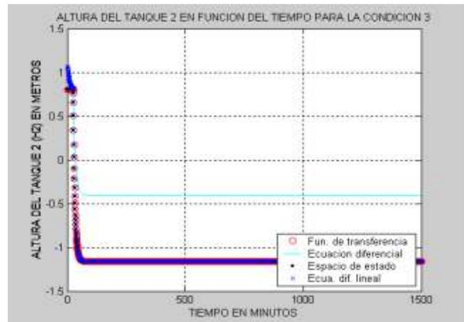
**Gráfica 3:** Altura de tanque 2 en función del tiempo, con cambio de flujo y encendido simultaneo de la bomba a los 25 min.
