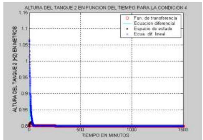
**Gráfica 4:** Altura de tanque 2 en función del tiempo, con la bomba apagada y caída del flujo a los 25 min.
