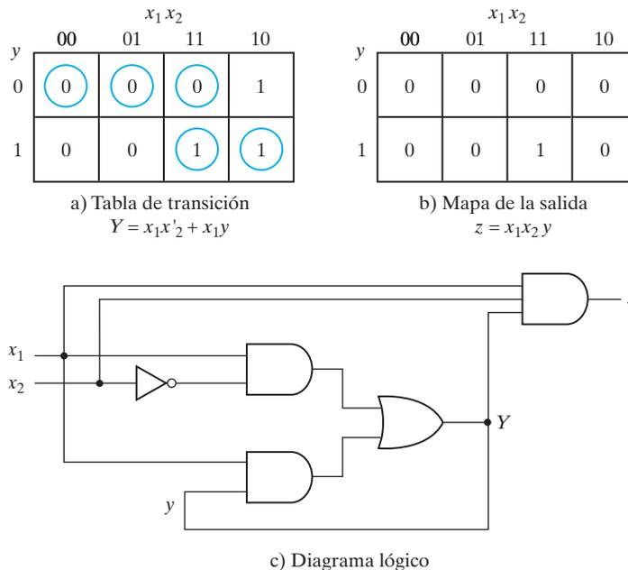
**FIGURA 9-5** Deducción del circuito especificado por la tabla de flujo de la figura 9-4b)
