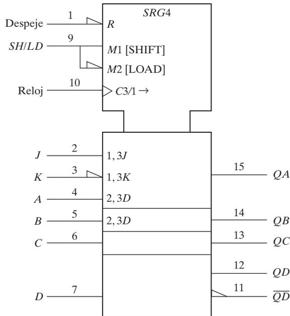
**FIGURA 12-11** Símbolo gráfico de un registro de desplazamiento con carga paralela, CI tipo 74195
