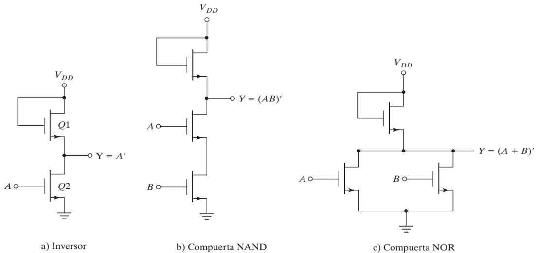
**FIGURA 10-21****Circuitos de lógica MOS de canal  $n$**
