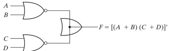
b) OR alambrado en compuertas ECL
