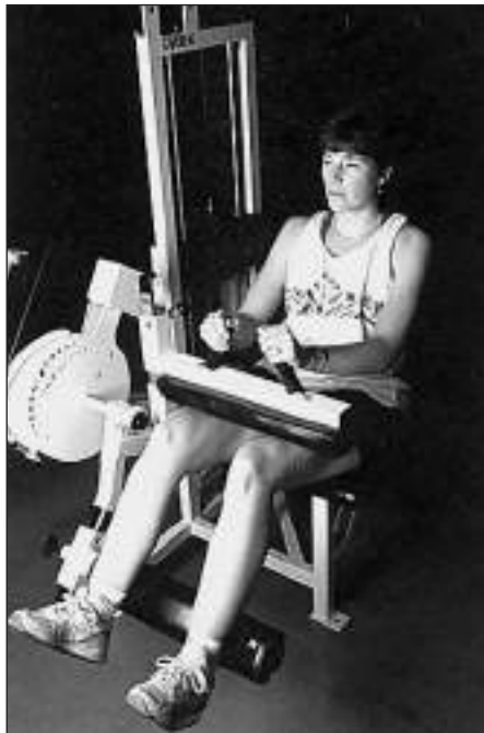
Figura 4.14 Un dispositivo de entrenamiento contra resistencia variable usando una leva para alterar la resistencia a lo largo de la amplitud del movimiento.
