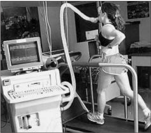
Figura 5.11 El equipo usado para medir el intercambio respiratorio de oxígeno y de dióxido de carbono.
