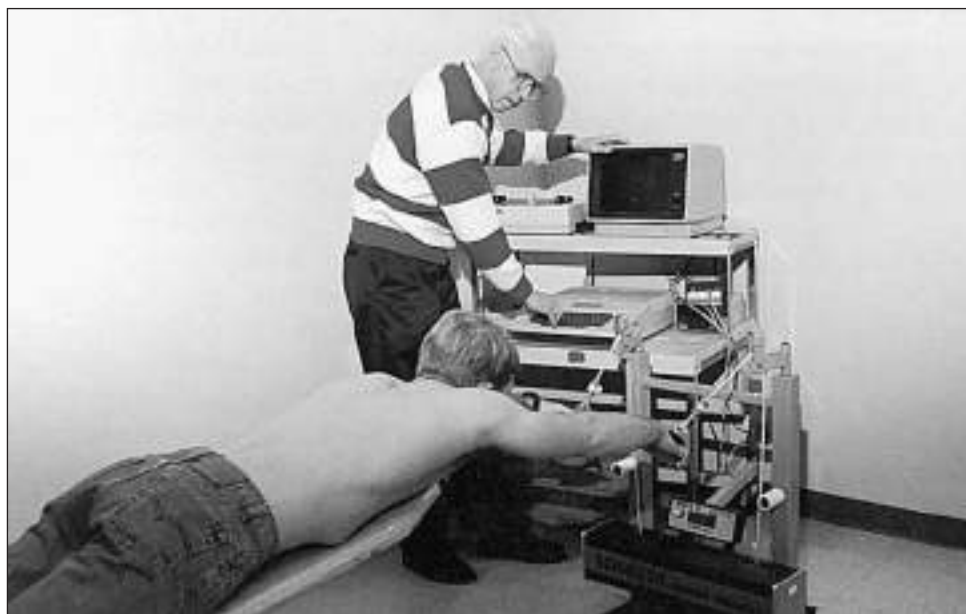
Figura 13.8 Mediciones de la fuerza y de la potencia de los brazos usando un banco de natación biocinético.
