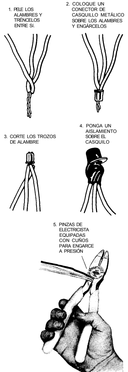
Fig. 31-11. Conexión de alambres con conectores de presión (Ideal Industries, Inc.).
