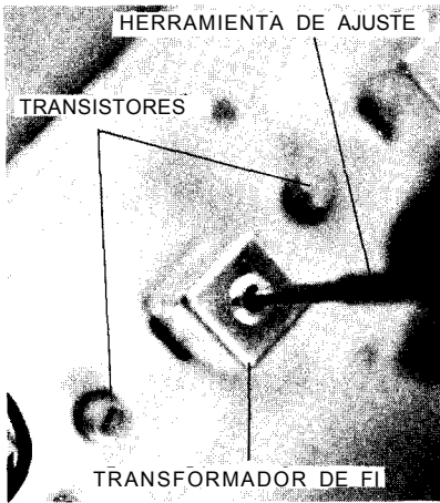
Fig. 40-15. (A) Etapa amplificadora de frecuencia intermedia; (B) ajuste del transformador de frecuencia intermedia regulando los núcleos de hierro móviles en las bobinas.
