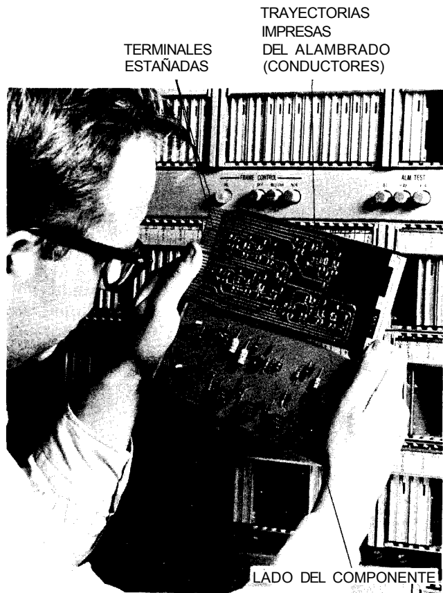
Fig. 23-7. Muestra de ambos lados de un módulo de circuito impreso insertable que se utiliza en una computadora (AT&T).
