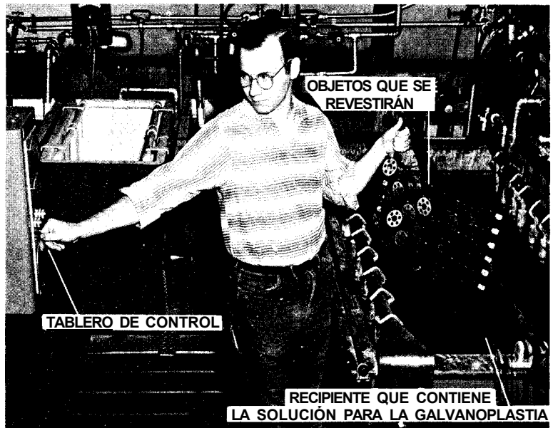
Fig. 30-2. Unidad para galvanoplastia en una planta industrial (Pioneer-Central Division of Bendix Aviation Corporation).
