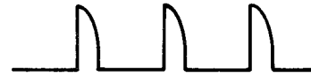
LA CONDUCCIÓN TARDÍA DE UN RCS DA UNA CORRIENTE MENOR DE CARGA
