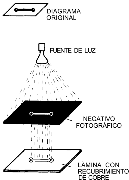
Fig. 23-4. Método de fotograbado básico para transferir el diagrama de distribución de un circuito impreso a una lámina con recubrimiento de cobre fotosensible.
