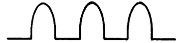
LA CONDUCCIÓN TEMPRANA DE UN RCS DA UNA CORRIENTE MÁXIMA DE CARGA
