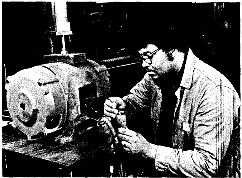
Fig. 32-18. Realización de las conexiones para probar un motor antes de certificar si es de alto rendimiento (Gould, Inc., Electric Motor Division).
