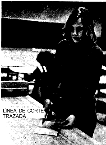
Fig. 28-5. Corte de una hoja metálica: (A) tijeras para lámina; (B) cizalla de corte a escuadra (Fotografía de la cizalla, cortesía de The Peck, Stow, and Wilcox Company).
