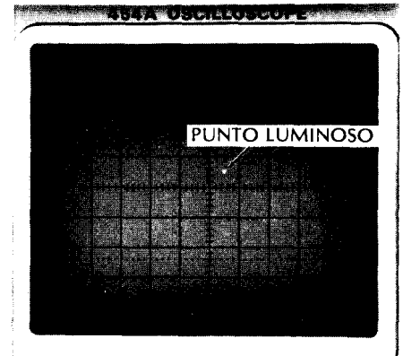
Fig. 47-3. Tubo electrónico de rayos catódicos del osciloscopio: (A) estructura del tubo; (B) diminuto punto o mancha de luz que aparece sobre la pantalla de un tubo de rayos catódicos (fotografía cortesía de Tektronix, Inc.).
