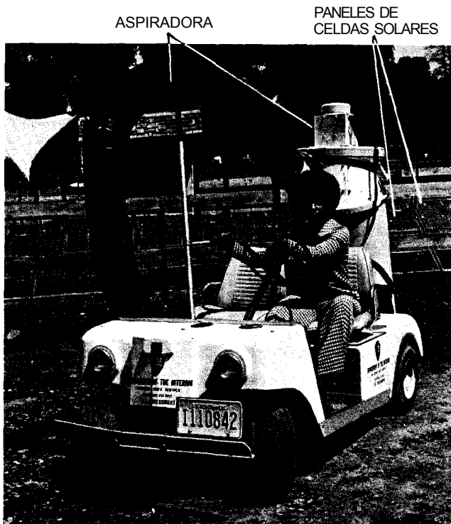
Fig. 35-16. Celdas solares (fotovoltaicas) se emplean para cargar la batería en un vehículo eléctrico adaptado con una aspiradora que se utiliza para recolectar basura (National Aeronautics and Space Administration).
