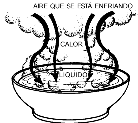
Fig. 34-1. Los líquidos absorben calor cuando se evaporan.
