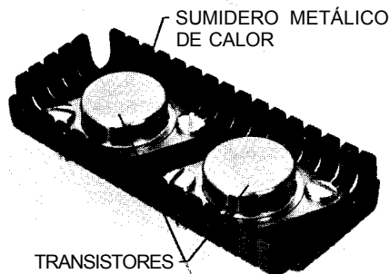
Fig. 21-8. Transistores de potencia montados en un sumidero o disipador de calor (International Electronic Research Corporation).
