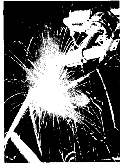
Fig. 33-4. Soldadura por resistencia en la industria. Las líneas blancas en esta fotografía representan las chispas de dicho proceso (Unimation, Inc.).
