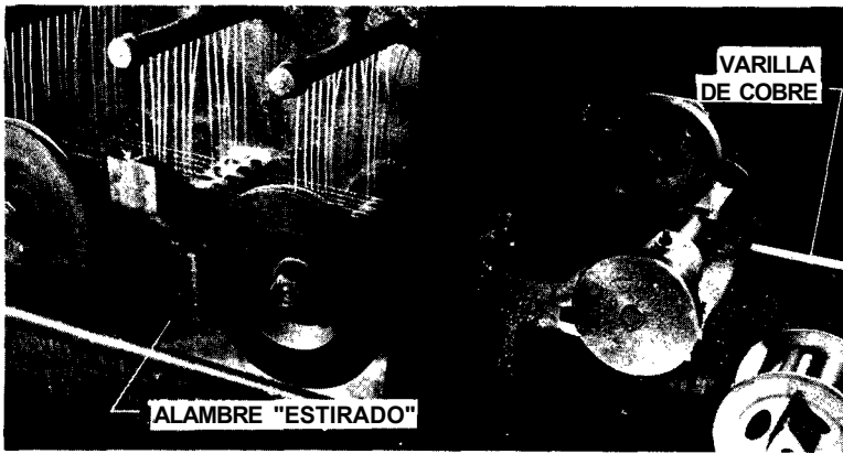
Fig. 2-2. El alambre se fabrica por medio de la tracción de varillas de cobre a lo largo de matrices (Rome Cable Corporation)
