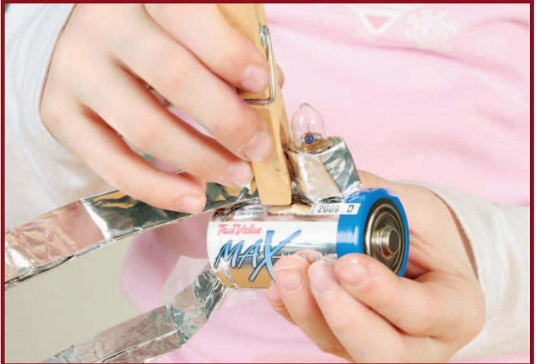
**¿Se enciende la bombilla si el punto de contacto toca el costado de la pila? No, porque la pila está cubierta de plástico. El plástico es un aislante.**
