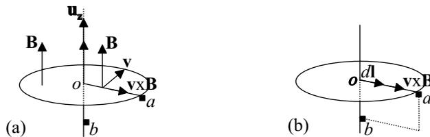
**Figura 7.6.** (a) Esquema del disco, su eje y el campo  $\mathbf{B}$ . (b) Camino de circulación y los vectores  $d\mathbf{l}$  y  $\mathbf{E}_{ns} = \mathbf{v} \times \mathbf{B}$ .
