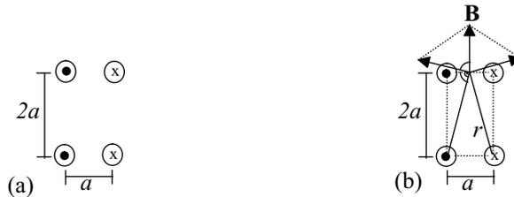
**Figura 7.28.** (a) Sección representando dos líneas bifilares. (b) Campo producido por la línea inferior en el punto medio de la superior.
