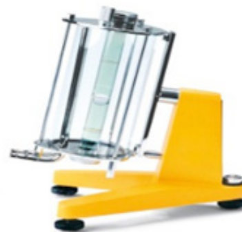
Figura 3. Viscosímetro de caída de bola. Fuente: Wisniewshi, 2005.
