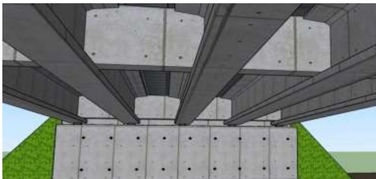
**Figura 7** Vista en 3D de la parte inferior del tablero del puente.
