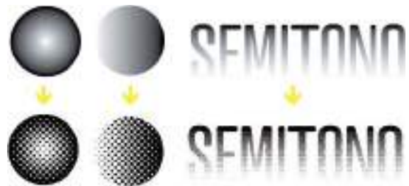
Figura 4.21. Aplicando el efecto semitono o halftone a varios objetos con relleno de degradado.
