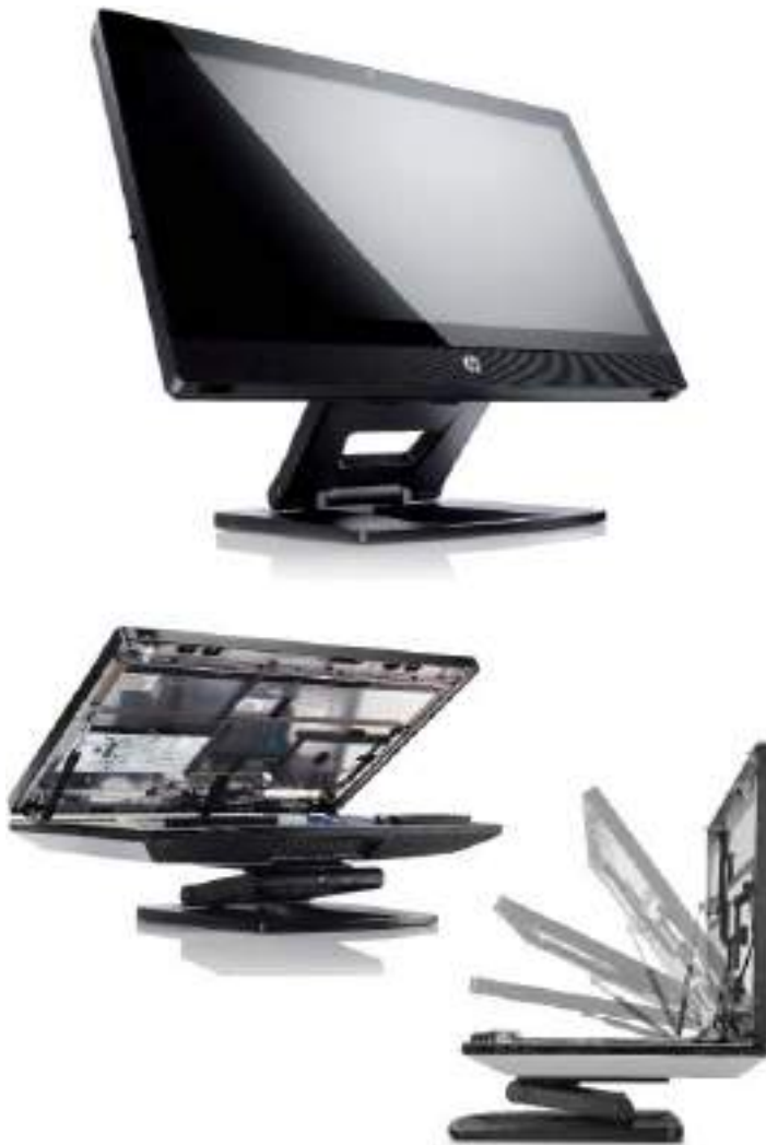
Figura 2.12. La estación de trabajo todo en uno, HP Z1, con monitor de 27" que integra la CPU.
