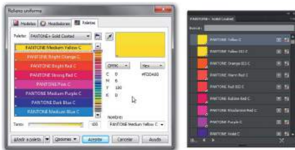
Figura 4.13. Los cuadros de diálogo para aplicar colores directos en CorelDRAW y en Illustrator.
